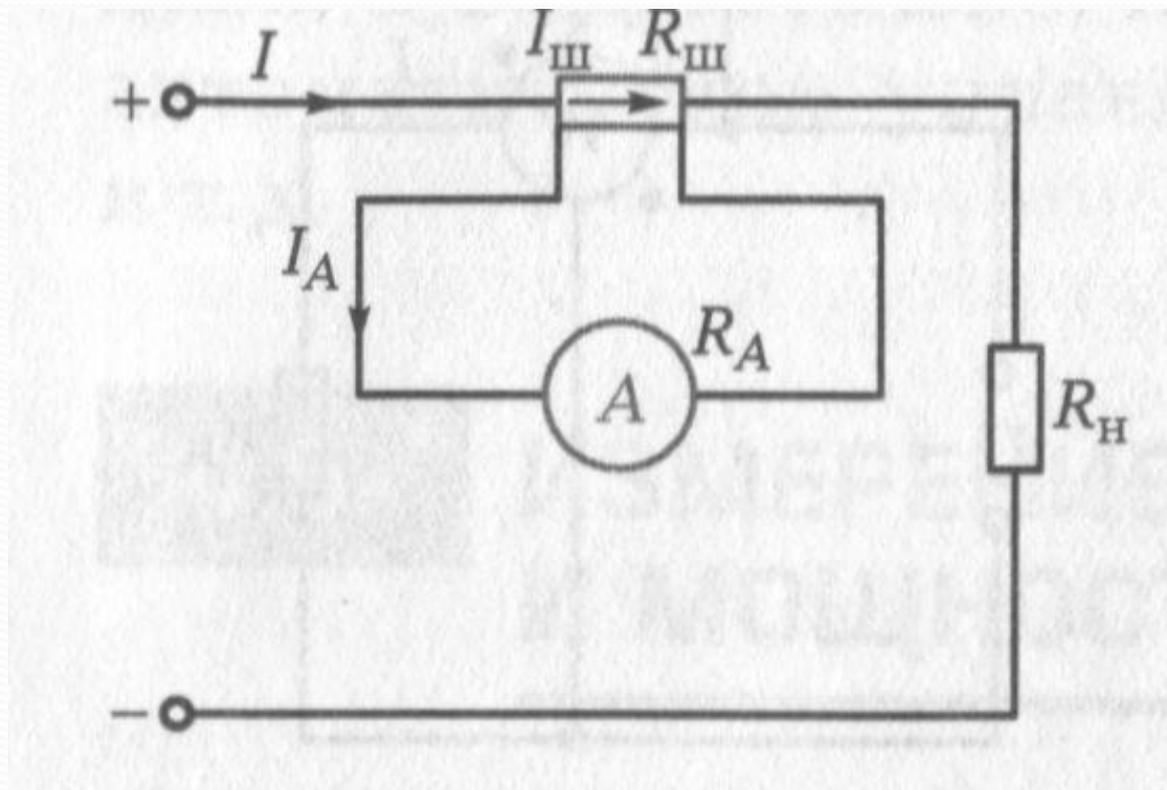
Распределение токов в амперметре  $I_A$  и шунте  $I_{ш}$  обратно пропорционально их сопротивлениям:
