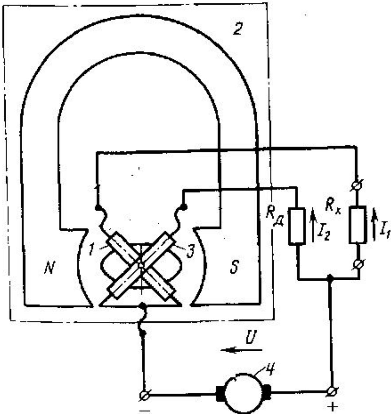
Магнитоэлектрический логометр 2 состоит из двух катушек 1 и 3, закрепленных на одной оси под углом  $90^\circ$  и жестко связанных друг с другом.
