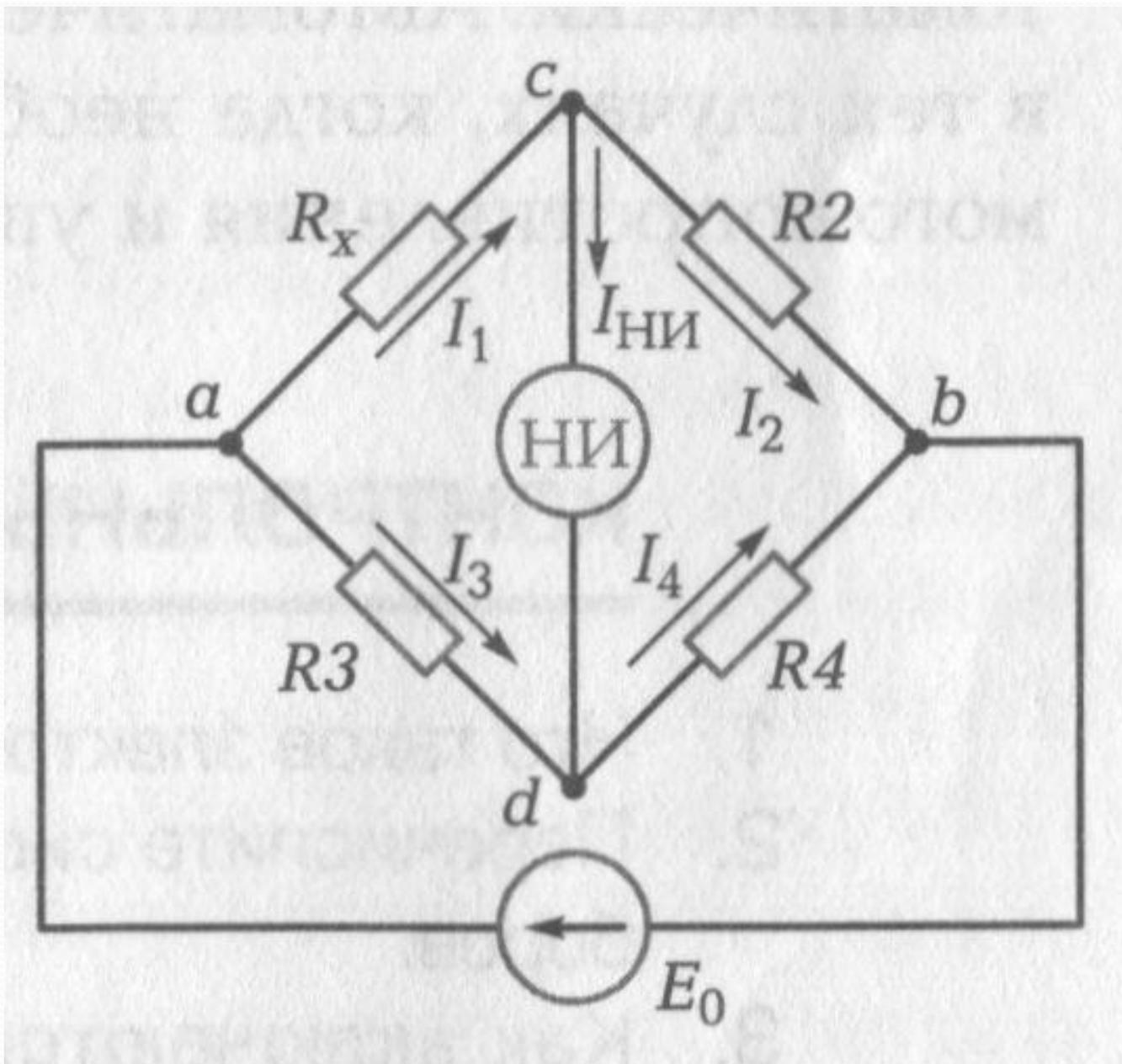
В одно плечо моста включают измеряемый резистор  $R_x$ , а другие три плеча состоят из резисторов  $R_2$ ,  $R_3$ ,  $R_4$ .
