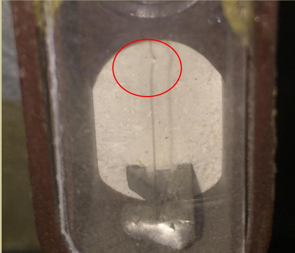
При пайки нити предохранителя не допускается наличия на ней следов излома, изгибов, которые увеличивают риск обрыва (прожога) предохранителя вследствие нарушения её внутренней целостности.
