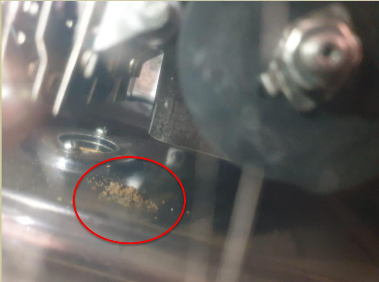
Наличие текстолитовой выработки на дне корпуса КПТШ, свидетельствует о наличии завышенного давления контактного подшипника на скос кодовой шайбы, длительная эксплуатация с завышенным давлением ведёт к заклиниванию подшипника или полному излому контактной пластины
