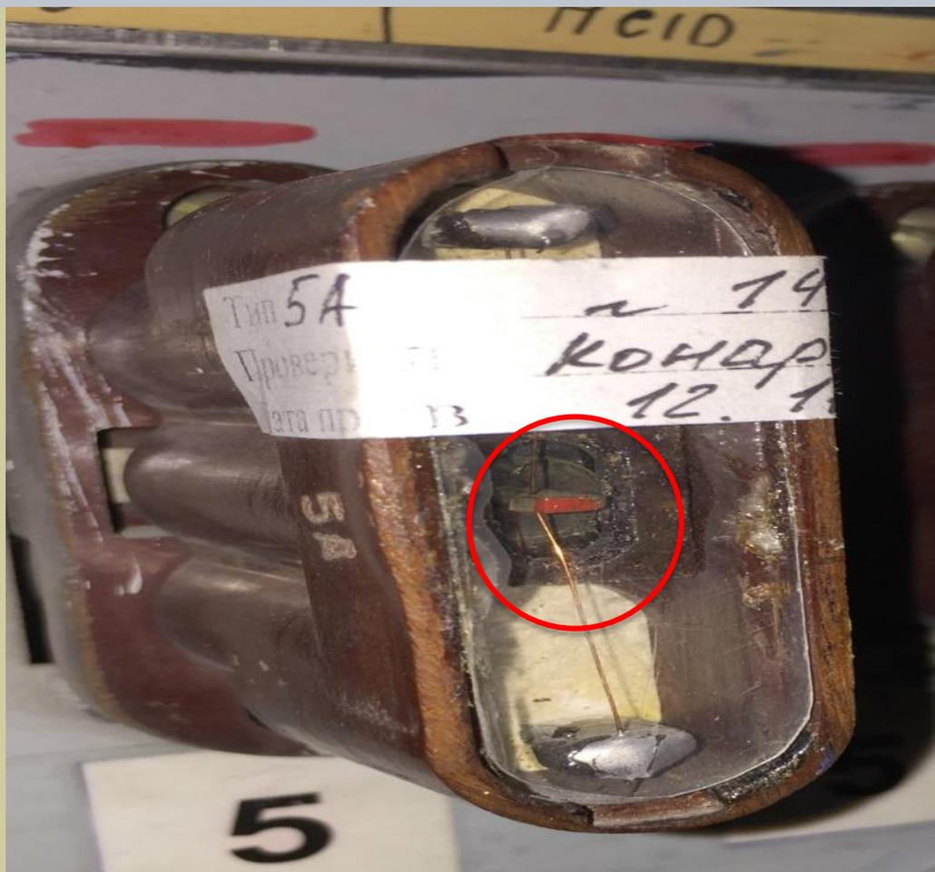
При провисании нити предохранителя увеличивается риск преждевременного выхода бойка из корпуса предохранителя за допустимые нормы, что спровоцирует ложное замыкание сигнальных контактов (согласно требованиям ТНК-ЦШ 0282-2019 выход бойка у предохранителей с напаянной плавкой вставкой не должен превышать 1 мм)
