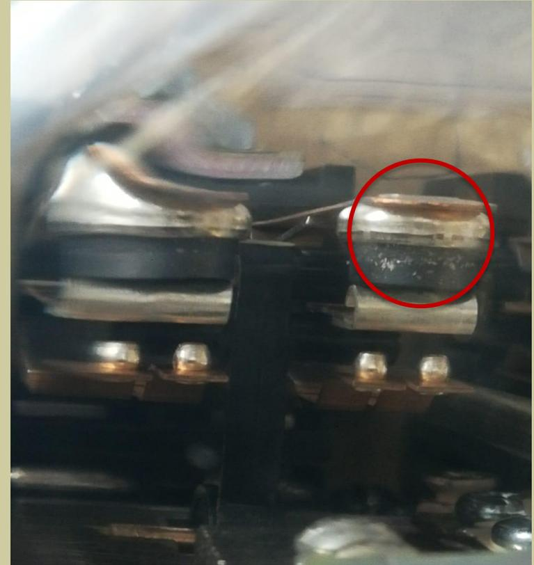
Выработка угольного контакта, а так же стягивание серебряной составляющей к осевому контакту свидетельствует о прохождении через них токов, превышающих расчетное значение, в следствие нарушения режима эксплуатации или норм регулировки.
