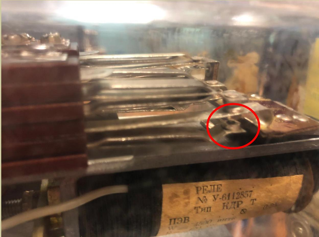
Подгар контактов свидетельствует об нарушении (или ухудшения в процессе эксплуатации) норм регулировки, в частности величины нажатия, скольжения, центровки наклёпов, а так же прохождением через них тока превышающего расчетное значение. Подгар контактов увеличивает риск возникновения завышенного переходного сопротивления.
