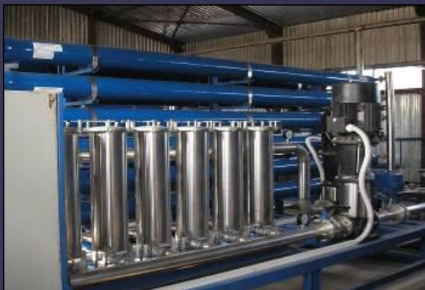
Установка обратноосмотическая, 450 м 3 /час г.Уральск, Казахстан
