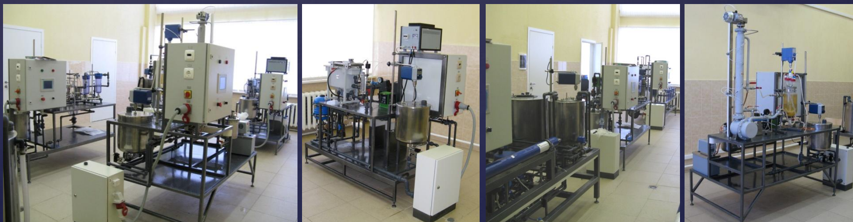
Испытательные стенды для проведения полного цикла экспериментальных работ по отработке комплексных высокоэффективных энерго- и ресурсосберегающих технологий очистки природных и сточных вод. Изготовлен для ВЛГУ
