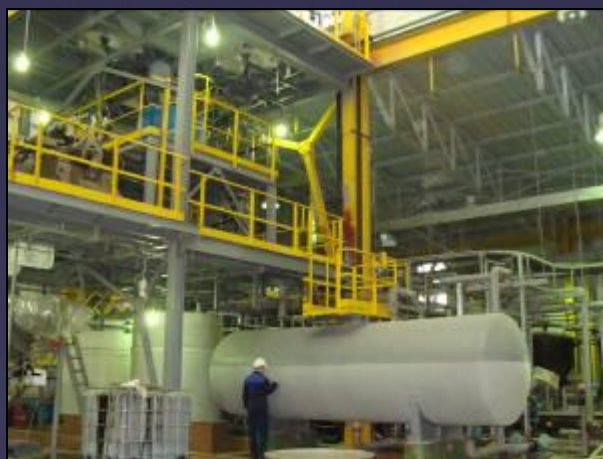
Установка регенерации и ОТР серной кислоты, 4 м 3 /час, Белоруссия
