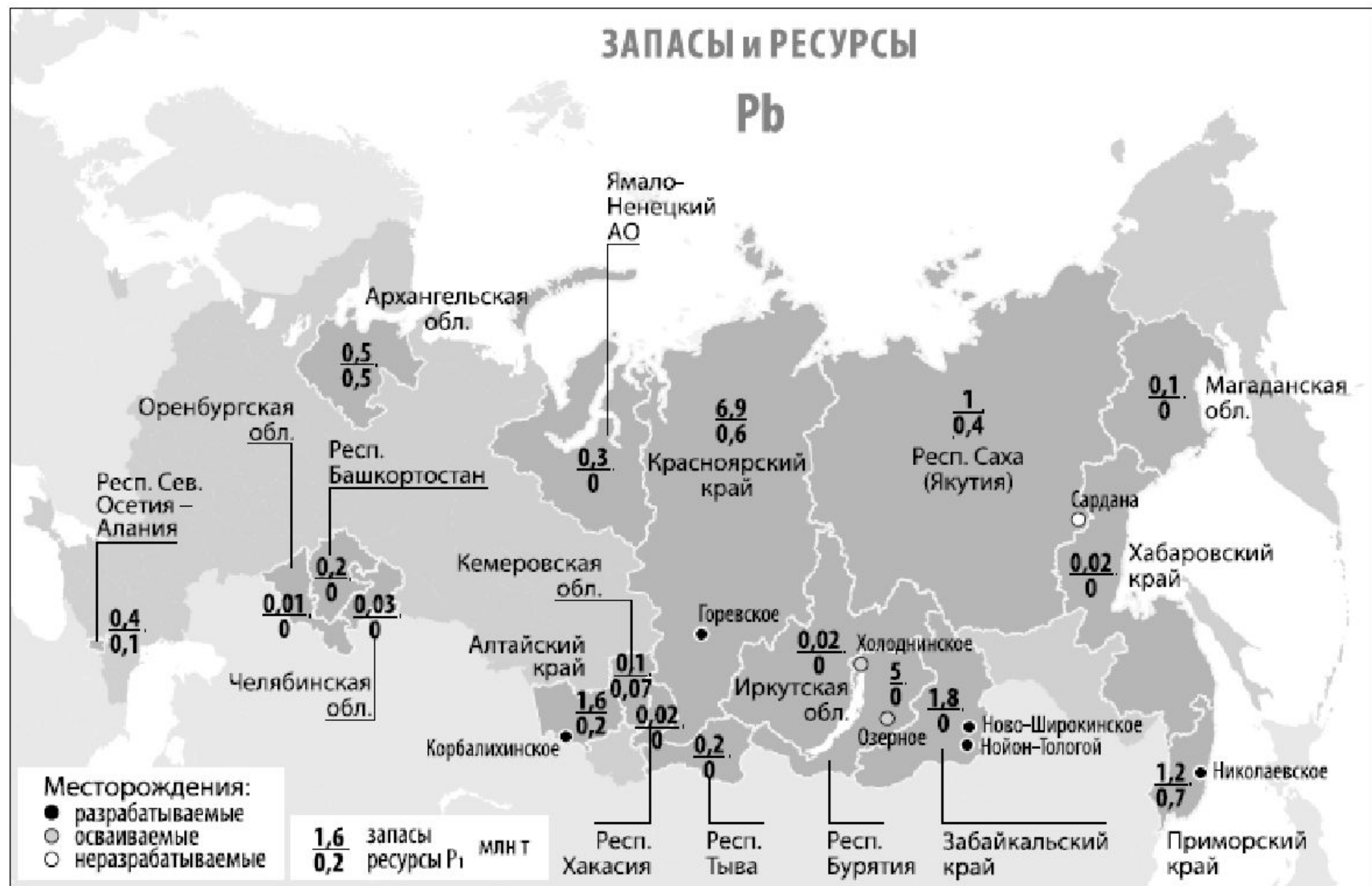
Основные месторождения свинца и распределение его запасов и прогнозных ресурсов категории P 1 по субъектам Российской Федерации, млн т
