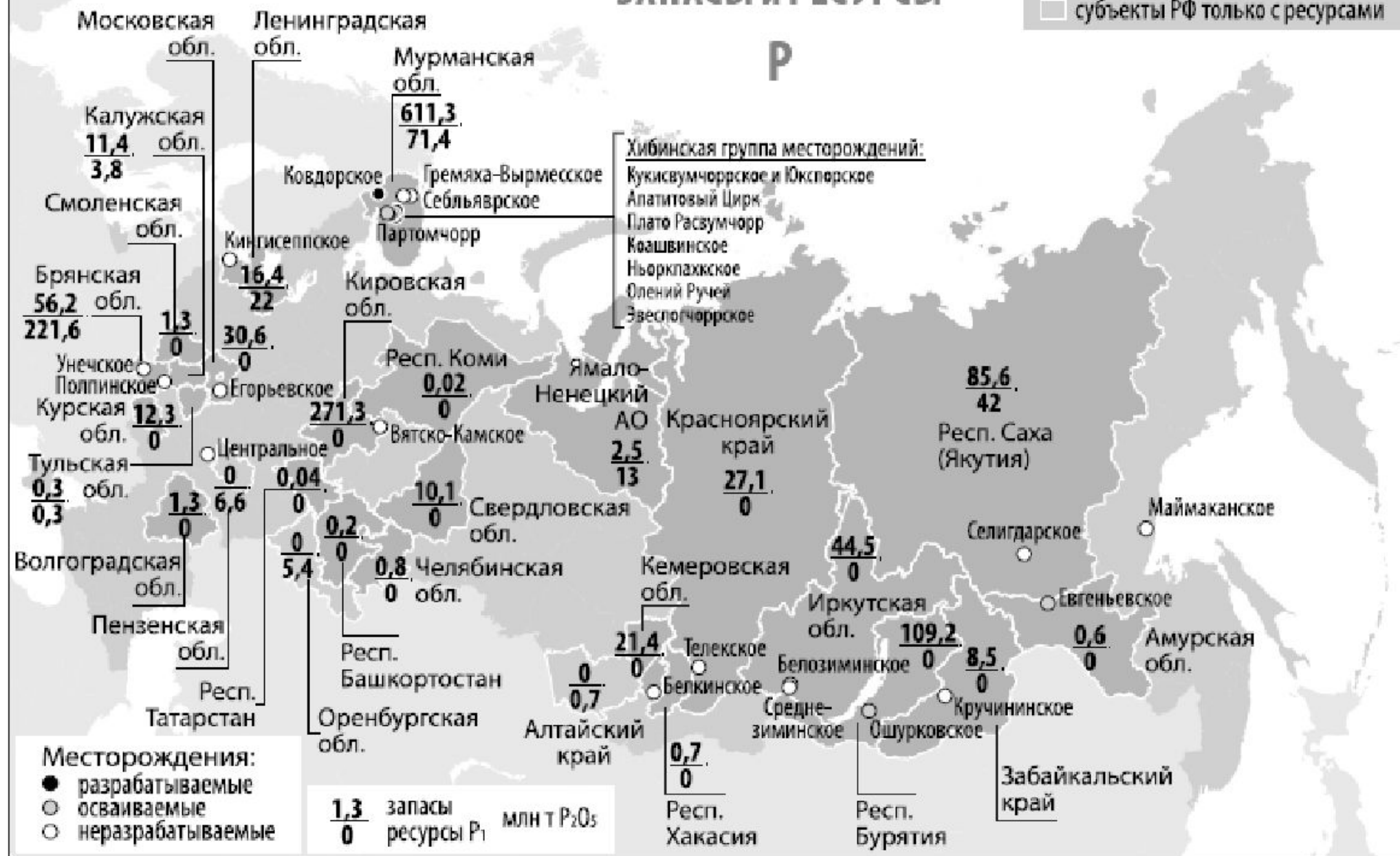
Основные месторождения фосфатных руд и распределение запасов и прогнозных ресурсов категории P 1 пентоксида фосфора по субъектам Российской Федерации, млн т P 2 O 5
