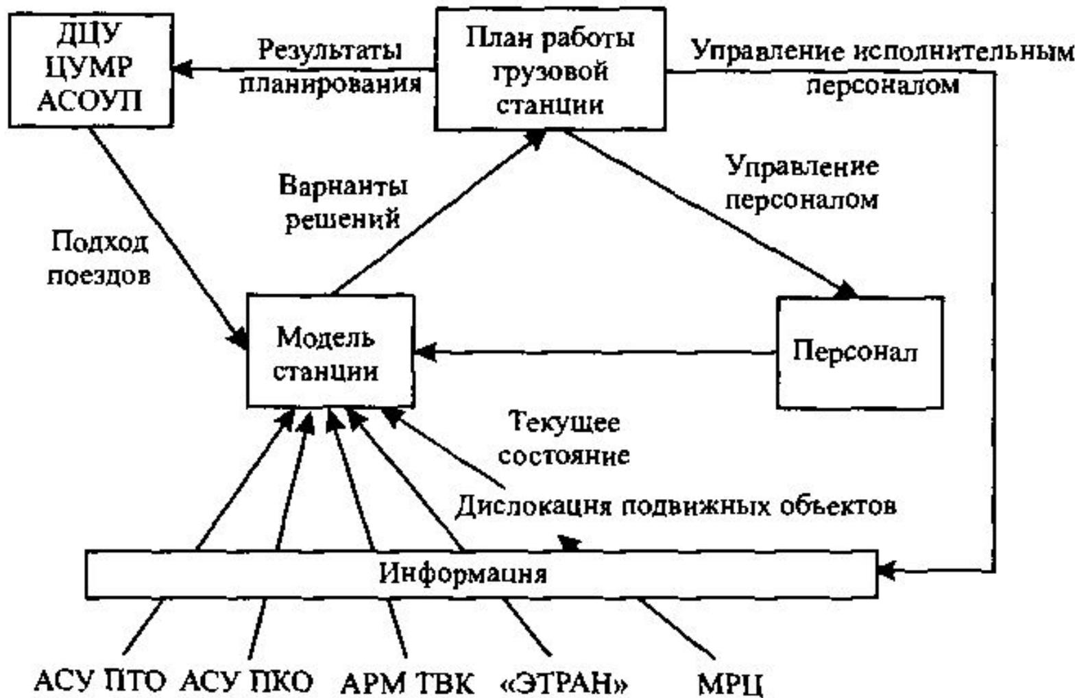
Рис. 3. Комплексная автоматизация управления грузовой станцией
