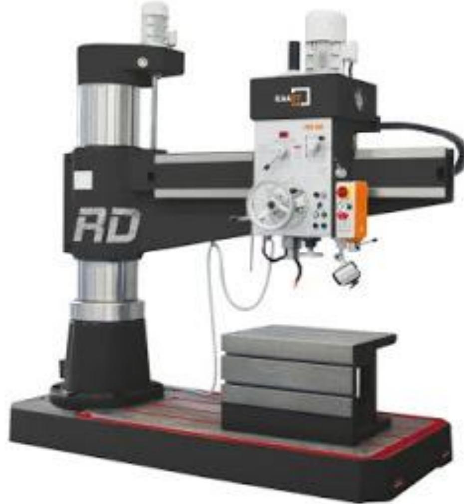
Пример радиально-сверлильного станка
