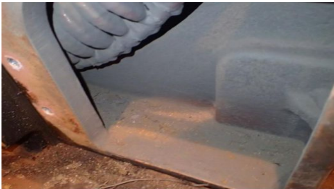
Рисунок 5 - Наличие металлической пыли и песка в
