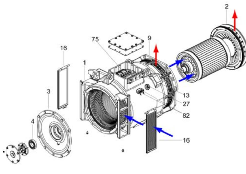
2 – Полиуретановый подшипник; 9 – Редуктор; 13 – Панель ввода; 16 – Магнитный щиток; 82 – Термометр
