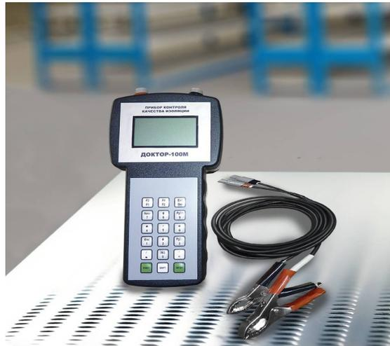
«Доктор-100М» предназначен для проверки качества изоляционных конструкций различного электрического оборудования тягового подвижного состава.
