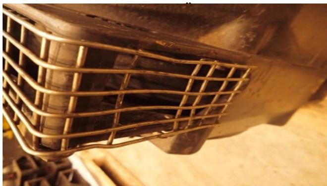
**Рисунок 4 - Повреждение изоляции на выходе из паза статорного железа**
