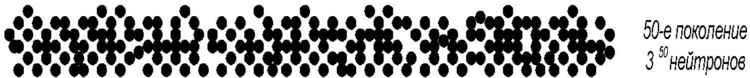
**Схема размножения нейтронов в цепной реакции деления ядер**
