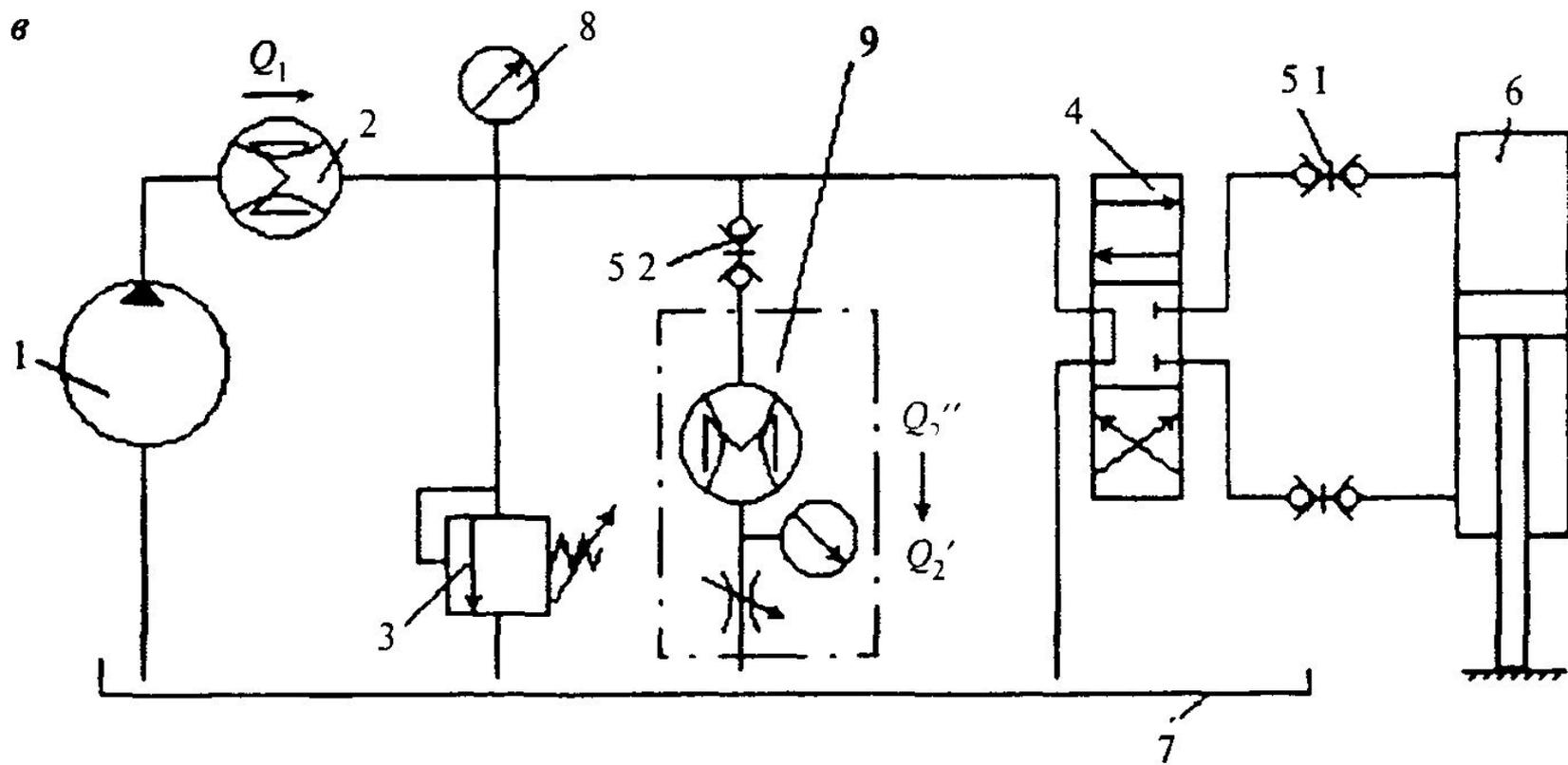
1 — насос, 2 — расходомеры, 3 — предохранительно-переливной клапан, 4 — распределитель, 5 — быстроразъемные муфты, 6 — гидродвигатель (гидромотор или гидроцилиндр), 7 — бак, 8 — манометр, 9 — гидротестер ( $Q_1$  — подача насоса,  $Q_2'$  — расход через клапан или гидротестер при подключенном гидроцилиндре,  $Q_2''$  — расход через клапан или гидротестер при отключенном гидроцилиндре (при разомкнутых муфтах),  $Q_3$  — расход на входе в гидромотор,  $Q_4$  — расход на выходе из гидромотора)
