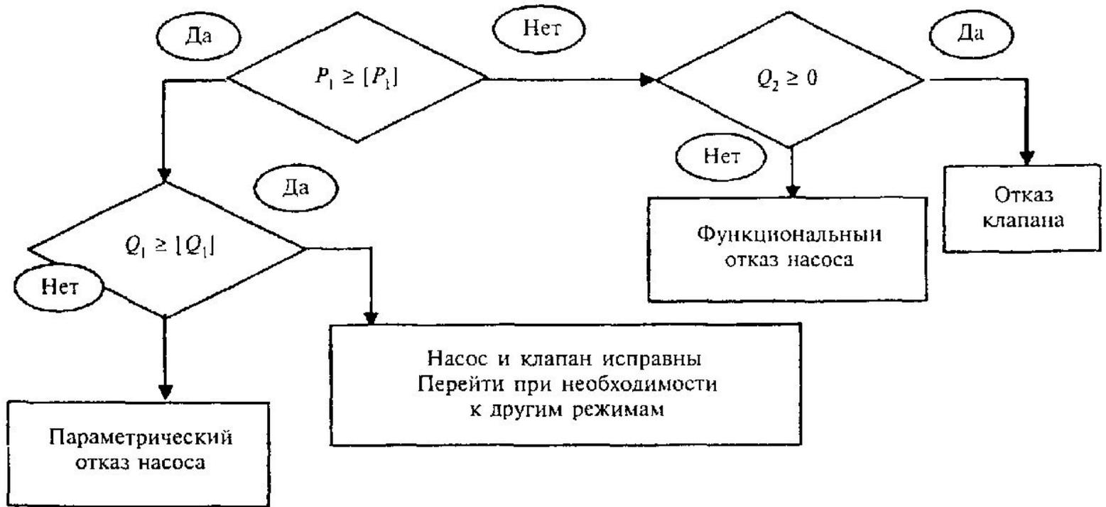
Рисунок 6 — Алгоритм диагностирования гидросистемы в клапанном режиме
