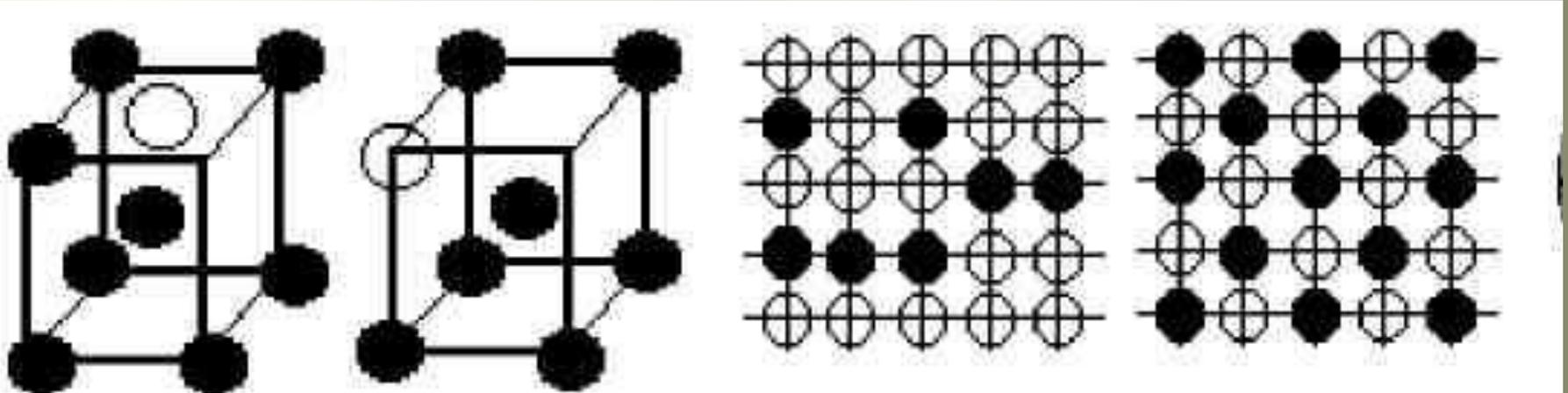
Способы образования сплавов
