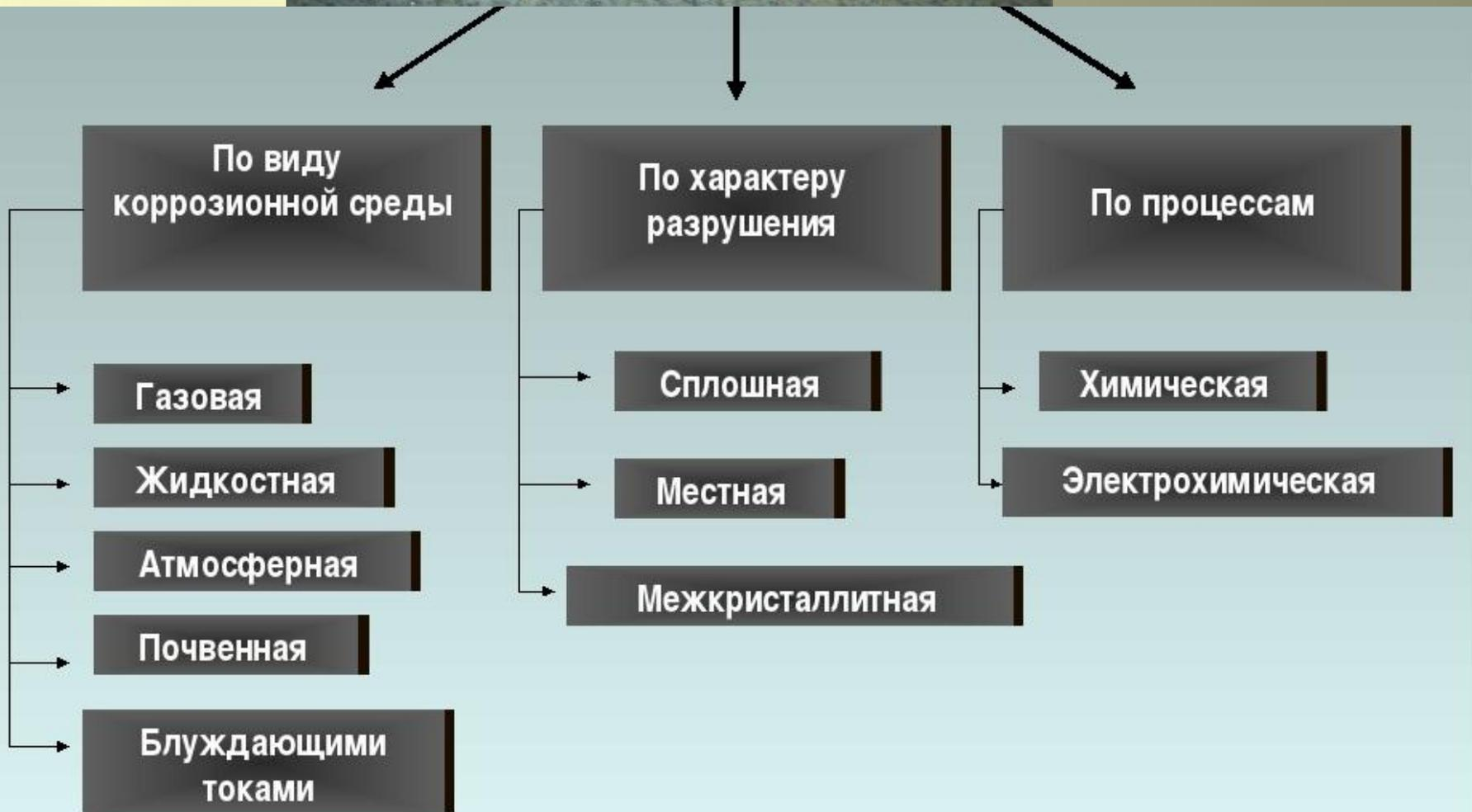
**ХИМИЧЕСКАЯ КОРРОЗИЯ** возникает при действии на металл при высоких температурах сухих газов, масел, бензина, керосина, окислителей, кислорода воздуха.
