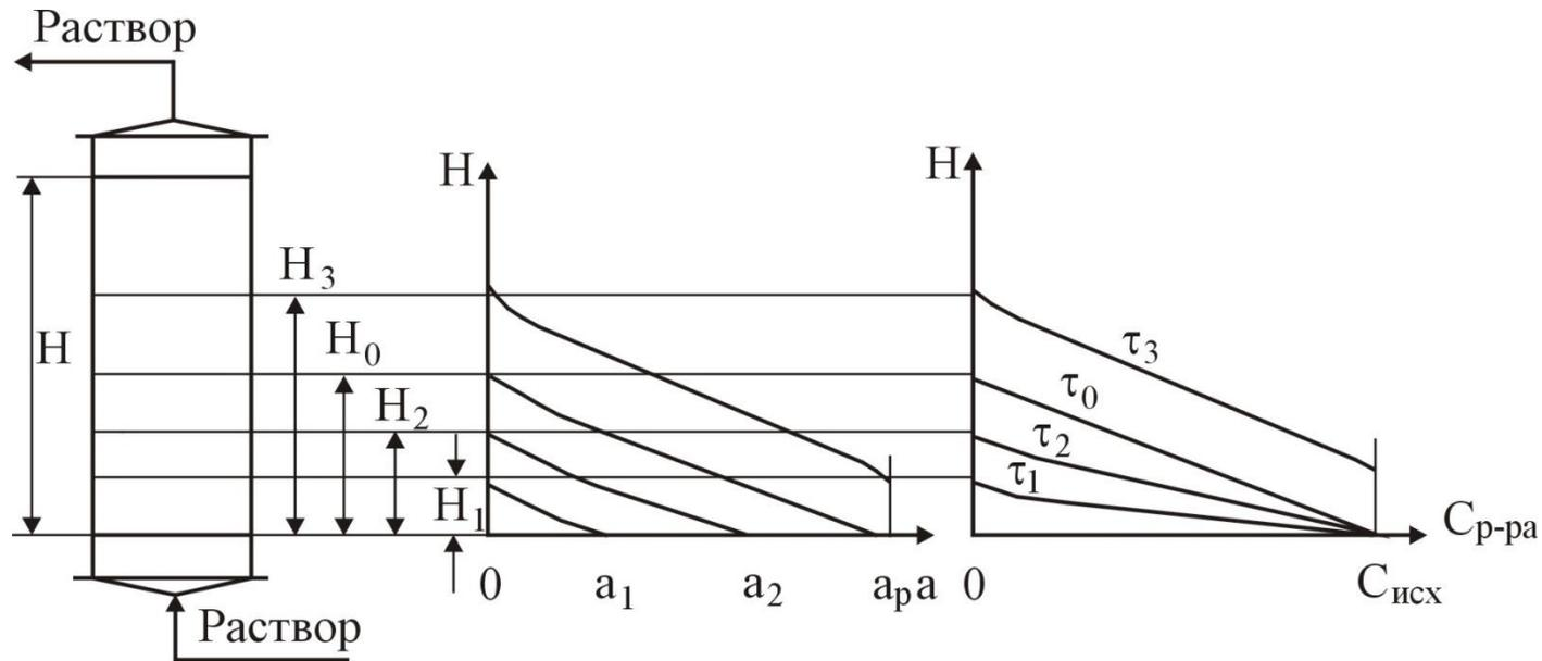
На рис. приведена **схема формирования фронта равных концентраций в неподвижном слое ионита.**
