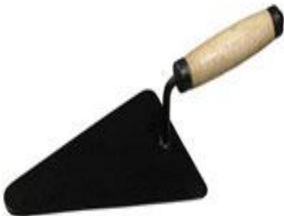
□ Представляет собой отшлифованную с обеих сторон стальную лопатку с деревянной ручкой. Предназначена для разравнивания раствора по кладке, заполнения раствором вертикальных швов и подрезки в швах лишнего раствора.
