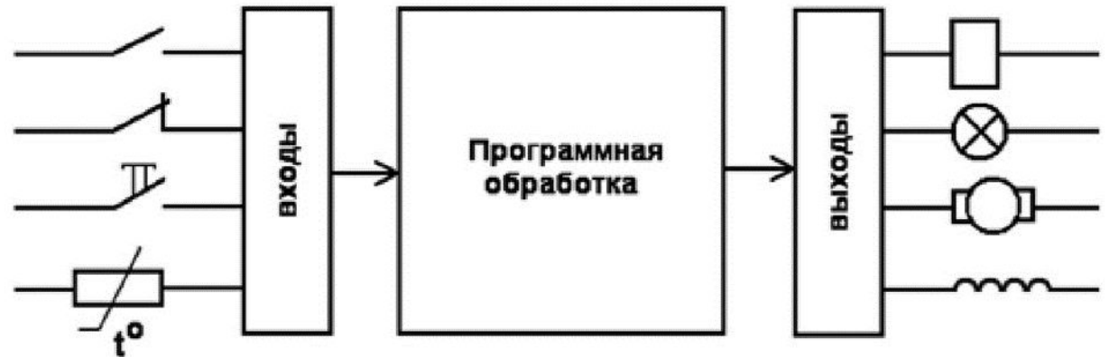
СТРУКТУРНАЯ СХЕМА ПЛК
