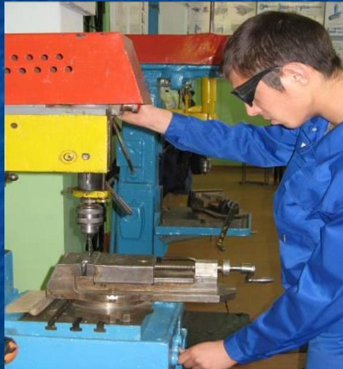
**Сверлением** называется операция образования отверстий в сплошном материале путем снятия стружки с помощью сверла, совершающего вращательное и поступательное движения относительно своей оси
