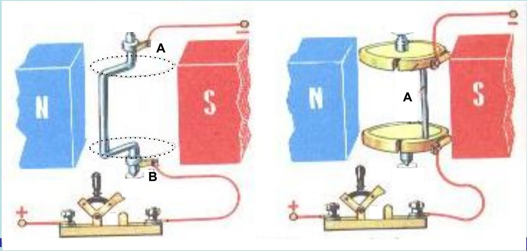
Между полюсами магнита находится  $\Pi$ -образный проводник. К концам проводника прижаты контакты – щётки **A** и **B**. Опишите, что будет происходить с проводником.
