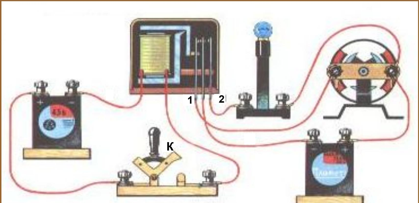
1. Что произойдёт в изображённой цепи при замыкании ключа *K* ?
