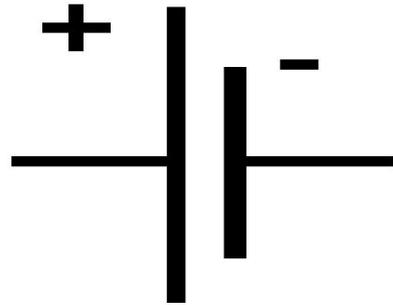
**Батарея из гальванических элементов**
