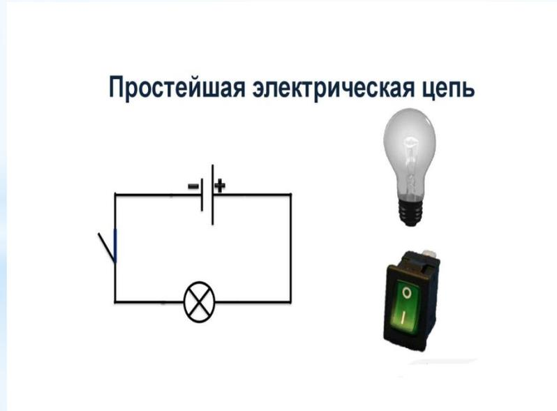
**Принципиальная электрическая схема** представляет собой графическое изображение электрической цепи, на котором её элементы изображаются в виде условных знаков.
