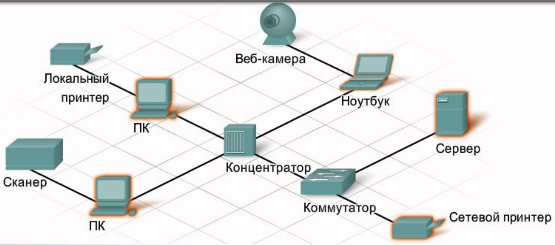
Сетевые устройства осуществляют связь между другими устройствами, в основном, узлами. Эти устройства осуществляют обмен данными и контролируют сетевой трафик. Примерами сетевых устройств служат концентраторы, коммутаторы и маршрутизаторы.
