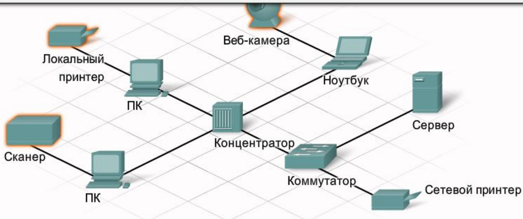
Узлы принимают и отправляют трафик пользователей. Узел - общее название для большинства устройств конечного пользователя. Узел имеет сетевой IP-адрес. Примерами узлов служат персональные компьютеры и принтеры, подключенные к сети.
