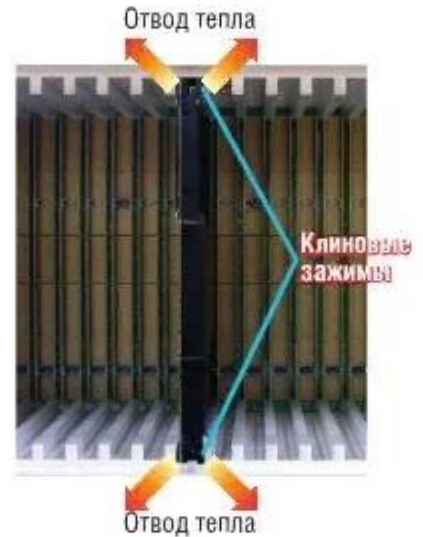
Модуль с кондуктивным теплоотводом, установленным внутри шасси
