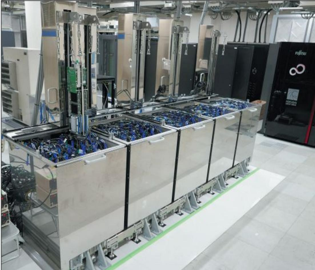
Суперкомпьютер Suiren, разработанный японской компанией PEZY Computing и ExaScaler Inc., использует однофазное охлаждение на основе жидкости 3M Fluorinert, что помогло ему войти в лист Green 500 самых высокопроизводительных компьютеров.
