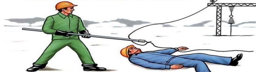
Спасатель должен надеть диэлектрические боты, работать в диэлектрических перчатках. Действовать необходимо изолирующей штангой или изолирующими клещами, рассчитанными на соответствующее напряжение. Остальные меры предосторожности те же, что и при низковольтной травме.
