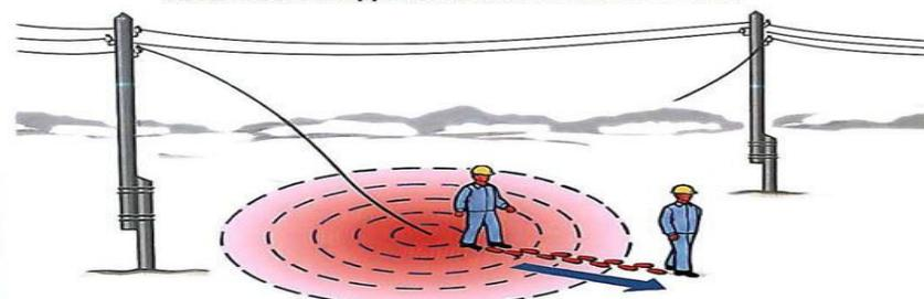
Если токоведущий элемент лежит на земле, возникает опасность напряжения шага. Двигаясь в зоне растекания тока, используйте диэлектрические галоши и коврики, сухие доски. При отсутствии защитных средств выходить из зоны растекания тока следует короткими шагами, передвигая ноги без отрыва их от земли и одной ступни от другой.
