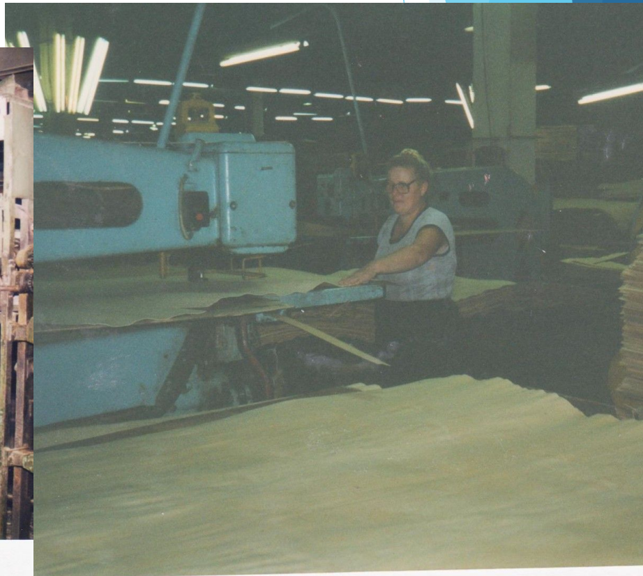
Станок для починки шпона.
