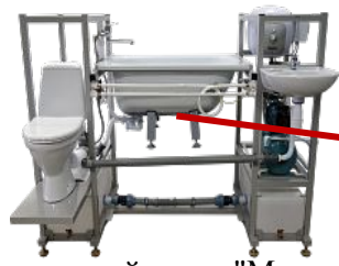
Лабораторный стенд "Монтаж сантехнического оборудования"
