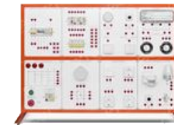
Лабораторный стенд «Электромонтаж в жилых и офисных помещениях»
