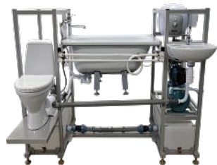
Лабораторный стенд "Монтаж сантехнического оборудования"
