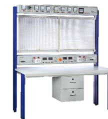
Лабораторный стенд для подготовки электромонтажников и электриков
