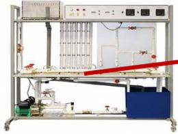
Типовой комплект учебного оборудования «Гидравлические сопротивления водопроводной арматуры»
