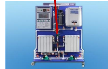
Лабораторный стенд «Энергосберегающие технологии в сфере ЖКХ»
