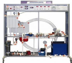
Лабораторный стенд "Датчики расхода, давления и температуры в системе ЖКХ"
