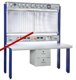
Лабораторный стенд для подготовки электромонтажников и электромонтеров
