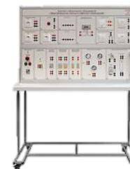
Лабораторный стенд «Рабочее место электромонтажника»
