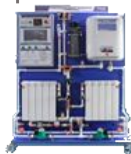
Лабораторный стенд «Энергосберегающие технологии в сфере ЖКХ»
