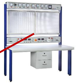
Лабораторный стенд для подготовки электромонтажников и электромонтеров
