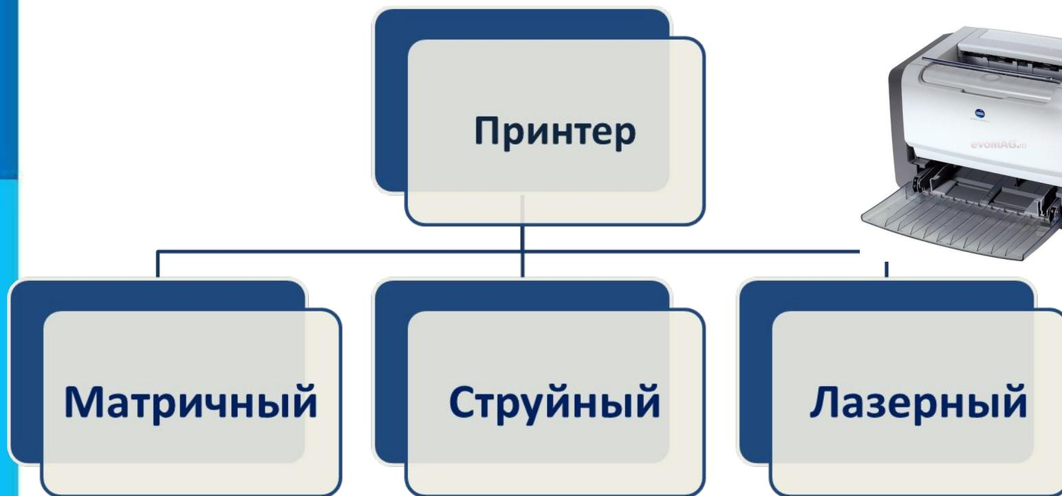
Для вывода документа на бумагу к компьютеру подключается печатающее устройство – **принтер**.
