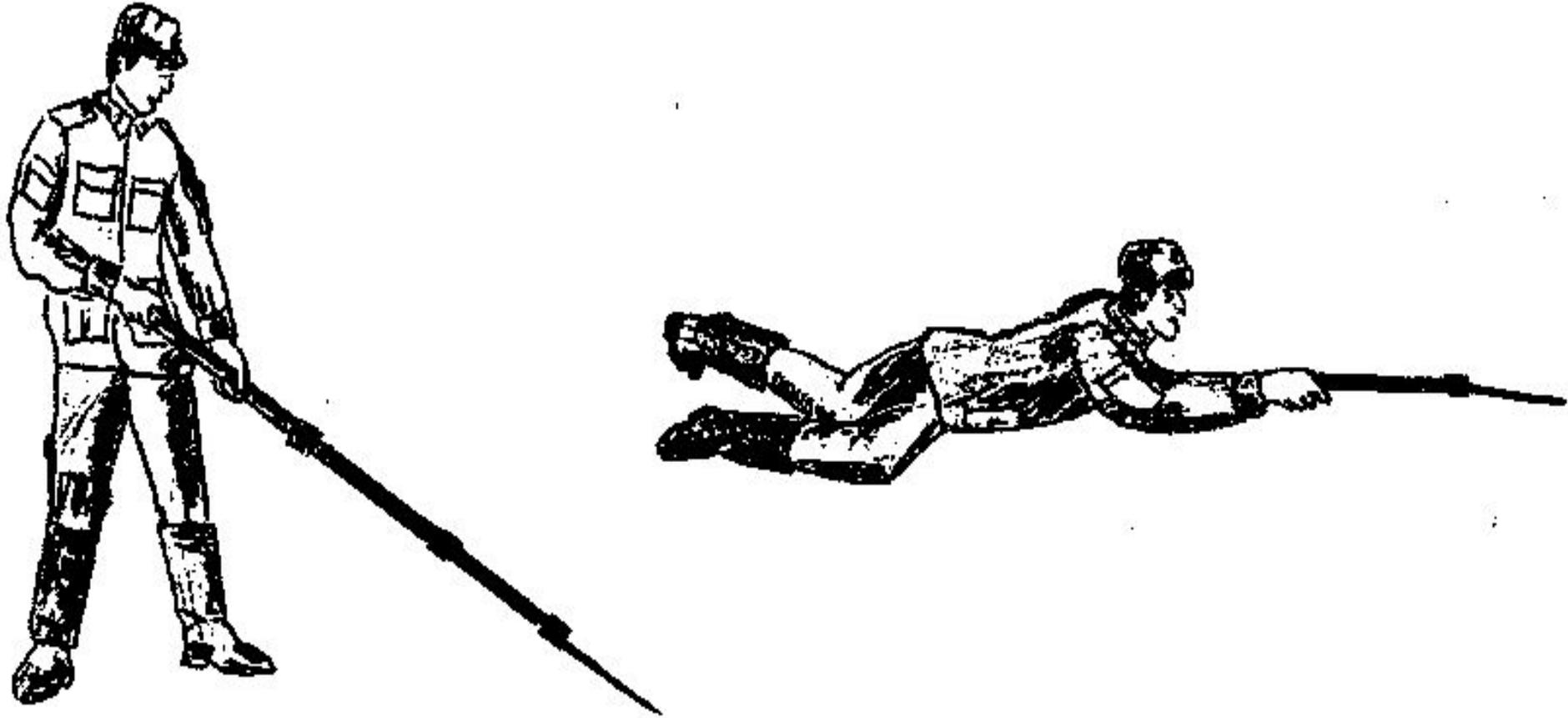
*К недостаткам щупов относятся невозможность использования их с твердым покрытием и при отыскании мин в мерзлых грунтах.*
