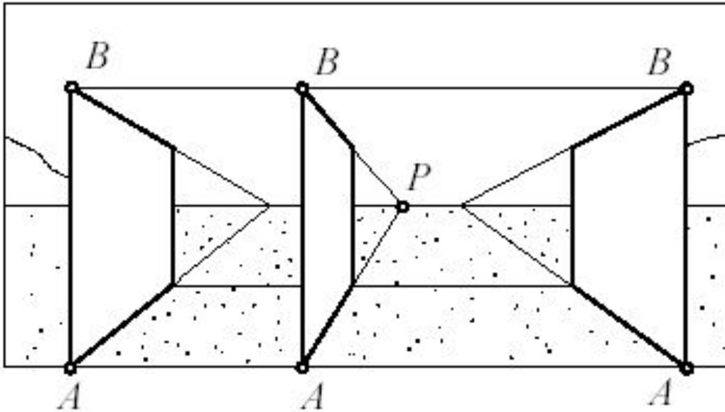
На рисунке показана перспектива трех вертикальных прямоугольных стен, передние ребра  $AB$  которых совпадают с картинной плоскостью. Длина стен разная, а высота всех трех стен одинакова, причем одна из них перпендикулярна картине (*какая?*). Боковая стена может быть использована как вспомогательный элемент при построении перспективы для переноса высотных отметок в заданную точку плана.
