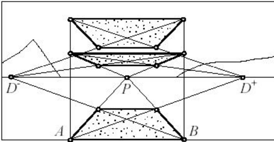
На рисунке показана перспектива трех горизонтальных плоскостей, расположенных на разной высоте. В каждой плоскости начерчены квадраты. Нижний квадрат располагается в предметной плоскости. Ближние стороны  $AB$  квадратов совмещены с картинной плоскостью.
