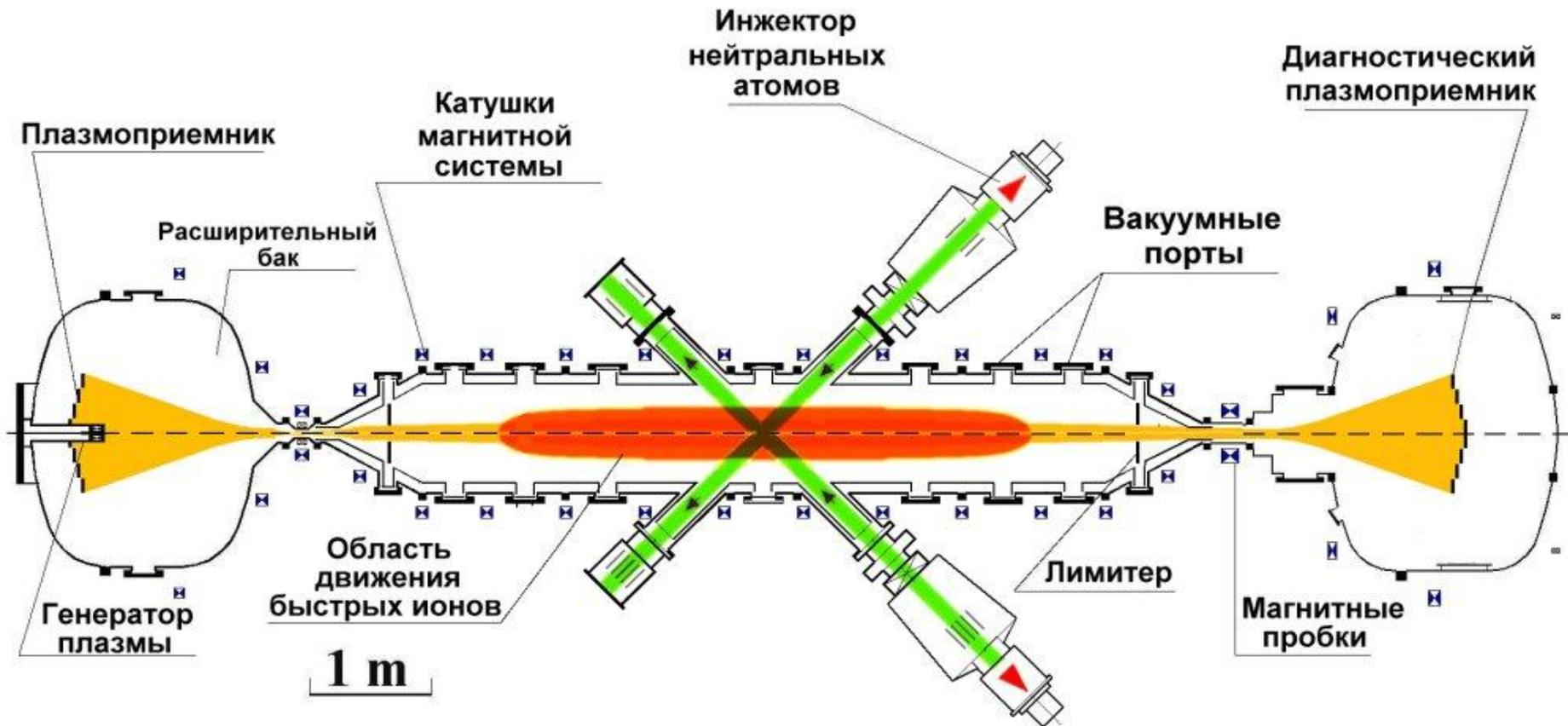
Схема установки ГДЛ, предназначенной для физического моделирования источника нейтронов на основе газодинамической ловушки
