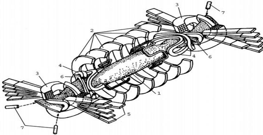
1 – плазма, 2 – катушки соленоида, 3 – катушки типа «бейсбол», создающие квадрупольные магнитные поля с минимумами в центрах концевых пробкотронов, 4 – переходные С-образные катушки, 5 – атомарные инжекторы концевых пробкотронов, 6 – газовые коробки – источники контролируемого напуска водорода с последующей ионизацией в соленоиде. 7 – стартовые плазменные пушки.
