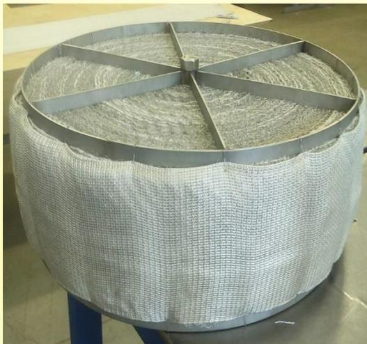
Каталитические пакеты на основе металлических гофрированных полос и специальных тканей для систем каталитического обезвреживания отходящих углеводородных газов
