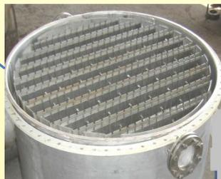
Многоточечный распределитель жидкости
