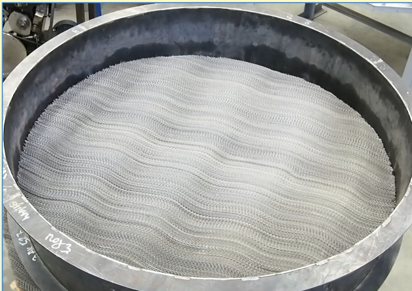
Сетчатые насадки типа «ШЕВРОН» из высоколегированных сталей
