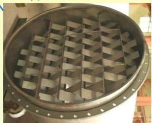
Структурированный перераспределитель парового потока
