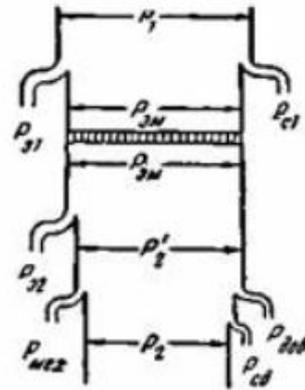
Рис. 3-29. Энергетическая диаграмма асинхронного двигателя.
