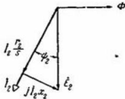
Рис. 3-33. Векторная диаграмма роторной цепи при неподвижном роторе.
