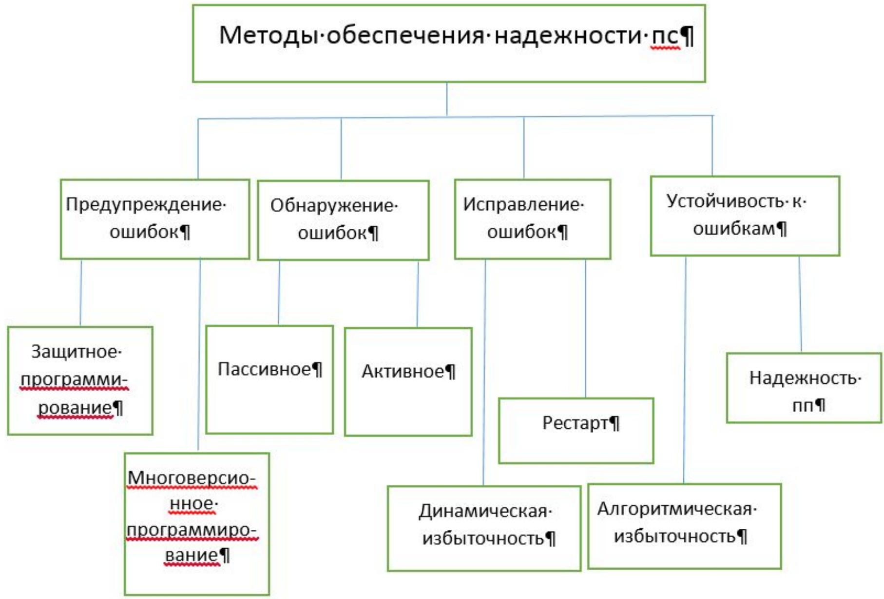
Схема обеспечения надежного ПС
