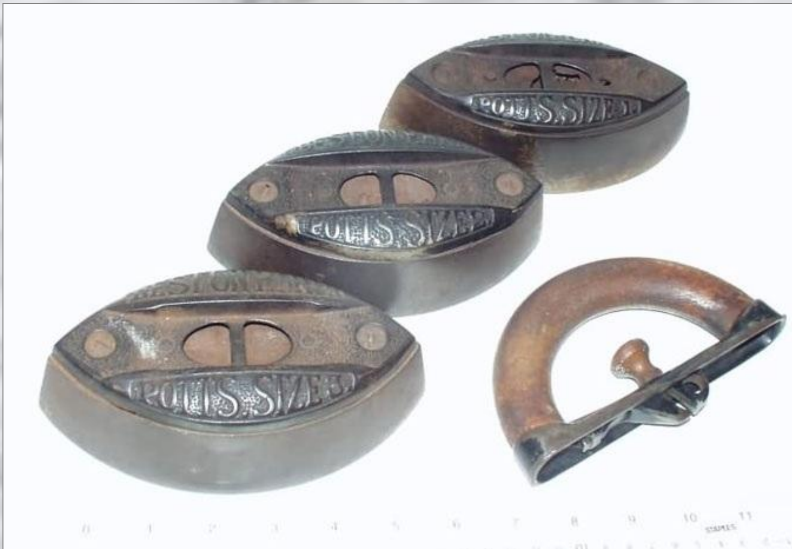
Утюги со съёмной ручкой. Пока один нагревался на печке, другим гладили.
