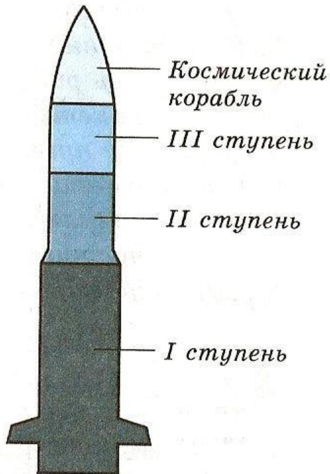
**Ступень – часть ракеты, которая содержит баки окислителем, горючим и двигателем.**
