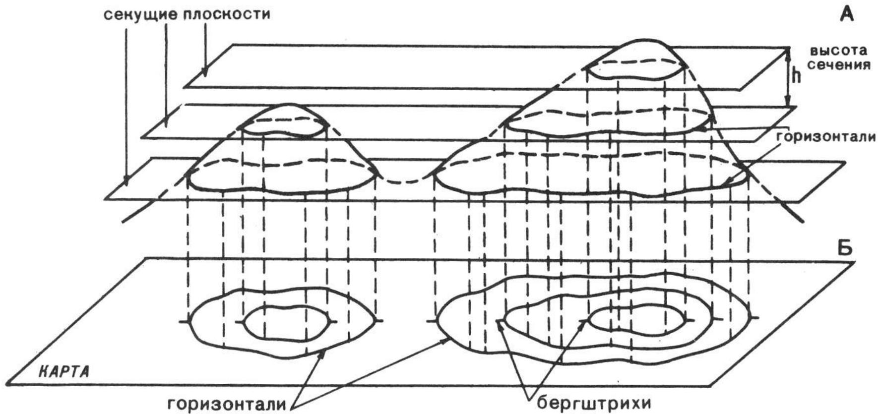
Рис. 30. Принцип образования горизонталей
