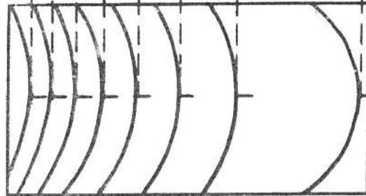
**Крутизна ската - угол наклона ската к горизонтальной плоскости**
