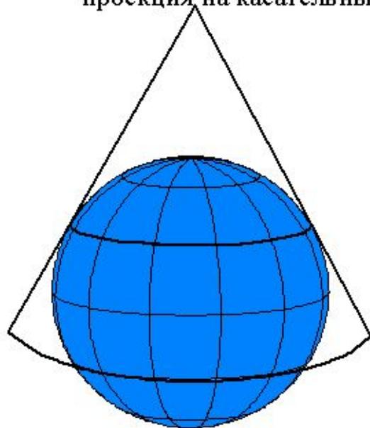
сетка в касательной проекции
