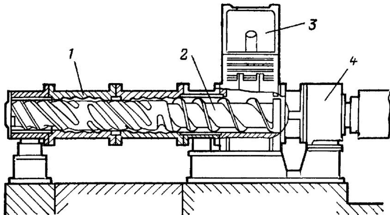
Устройство непрерывного смесителя типа «Трансфермикс»
