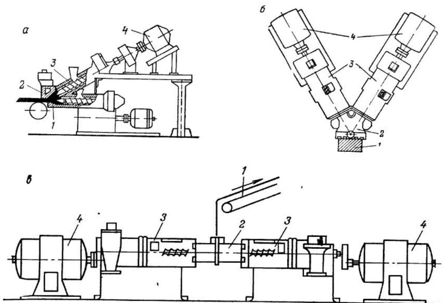
Схема расположения двух червячных машин при выпуске протекторов из двух разных резин и 2—3 деталей:
