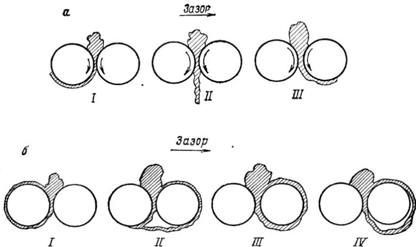
Явление перехода смеси при вальцевании на задний валок в зависимости от зазора :
