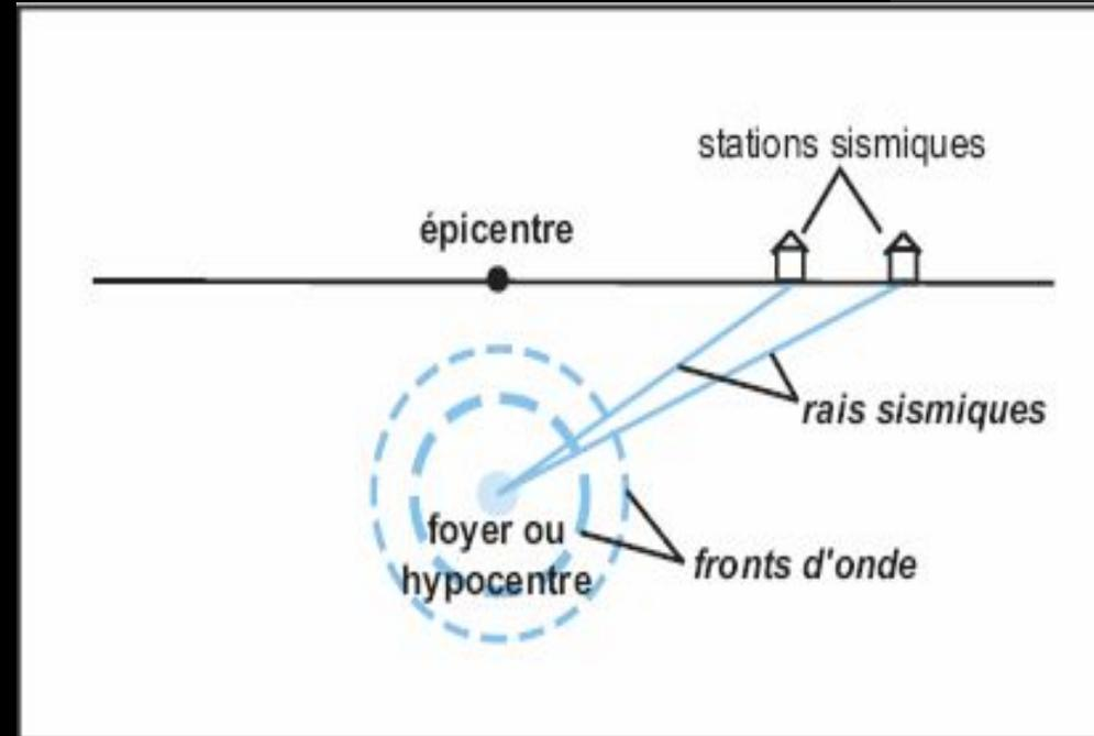
De multiples **stations sismiques** permettant
