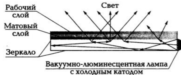
Рис. 4.6. Подсветка в мониторе по DSTN ( Double Super Twisted Nematic )-технологии
