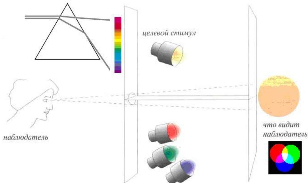
Пропустили белый свет через призму, которая разложила его на составляющие по длинам волн спектра. Из полученного спектра выделяли узкоспектральную полосу. Взяли трехстимульную систему раздражителей RGB. Открытие состояло в том, что для стандартного наблюдателя разные комбинации RGB вызывают одинаковые цветовые ощущения со светом определенной длины волны.
