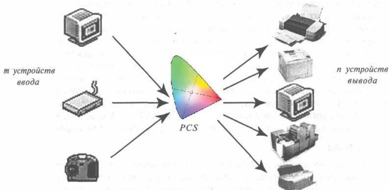
Пространство PCS служит мерилom для определения цвета. В описании стандарта ICC фактически используются два разных пространства (CIE XYZ и **CIE LAB**) в качестве пространства привязки разных типов профилей.
