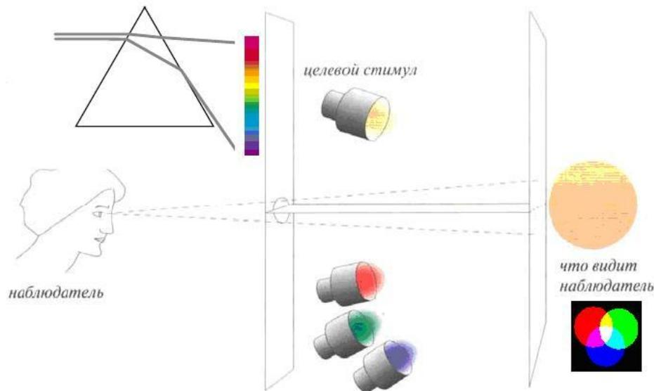
Узкоспектральный свет и комбинированный свет от RGB источников проецировали на экран. Наблюдатель изменял интенсивности RGB источников, пока цвета на экране не совпадали.
