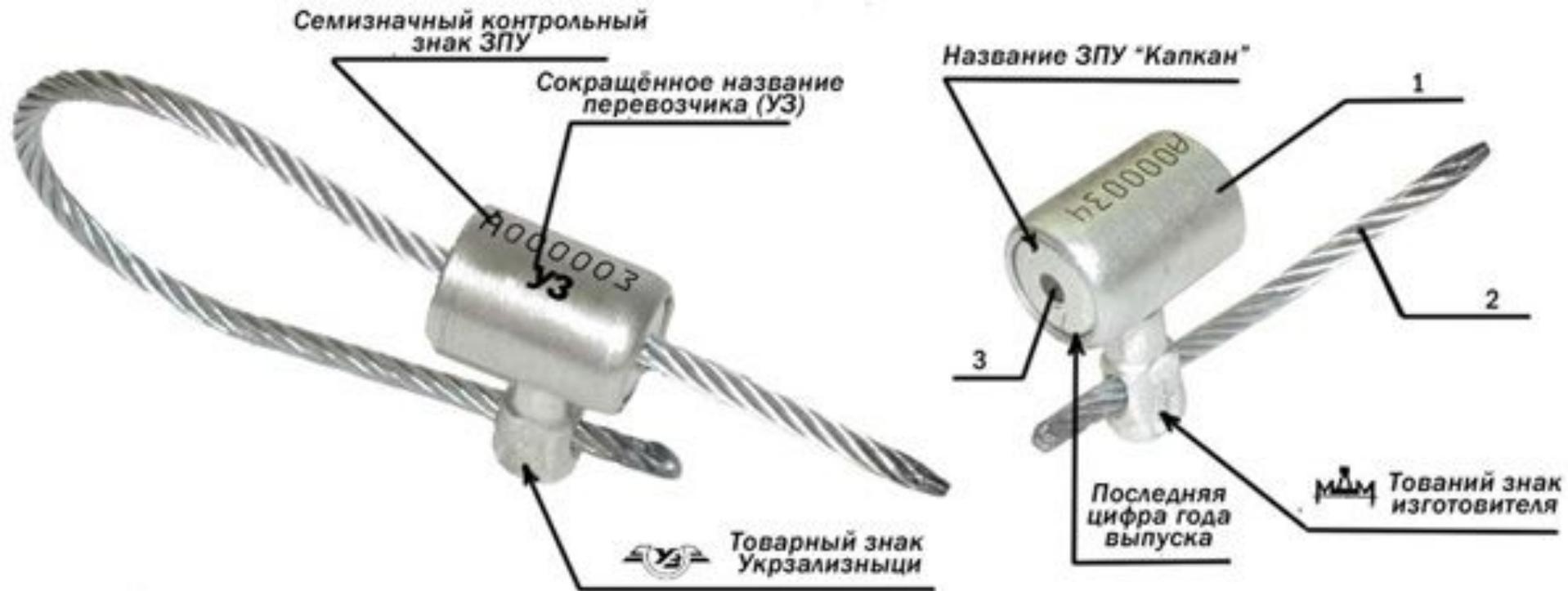
1 - корпус, 2- канат, 3 - механизм фиксации, расположенный в корпусе 1
