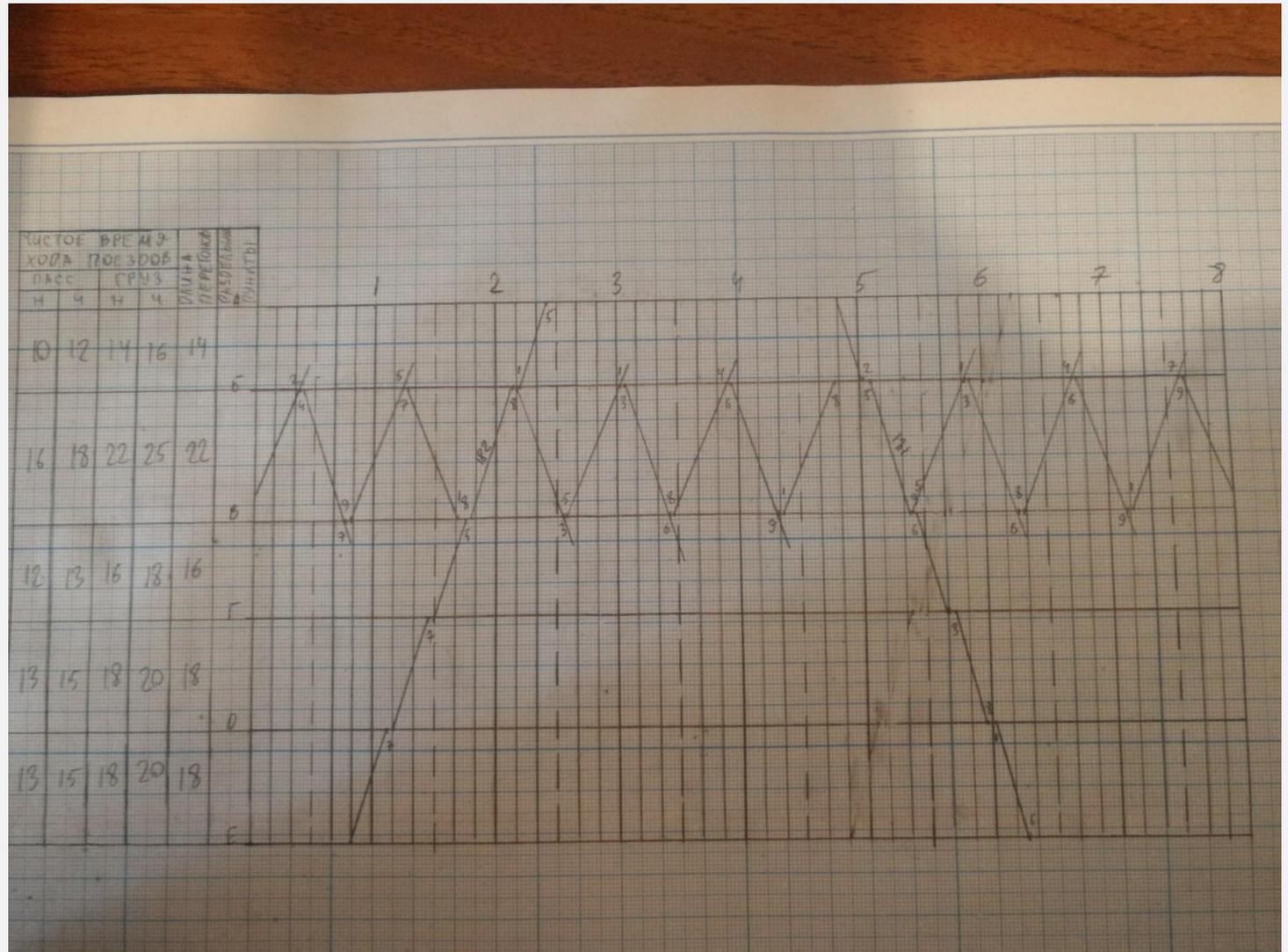
Принцип построения графика при автоблокировке практически не отличается. Вместо интервала попутного следования там появляются «пакеты» которые необходимо учесть при построении (пакет – поезда, идущие параллельно с интервалом в 10мин)
