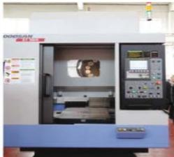
Токарный высокопроизводительный центр PUMA 280LM с ЧПУ Fanuc OiTD
