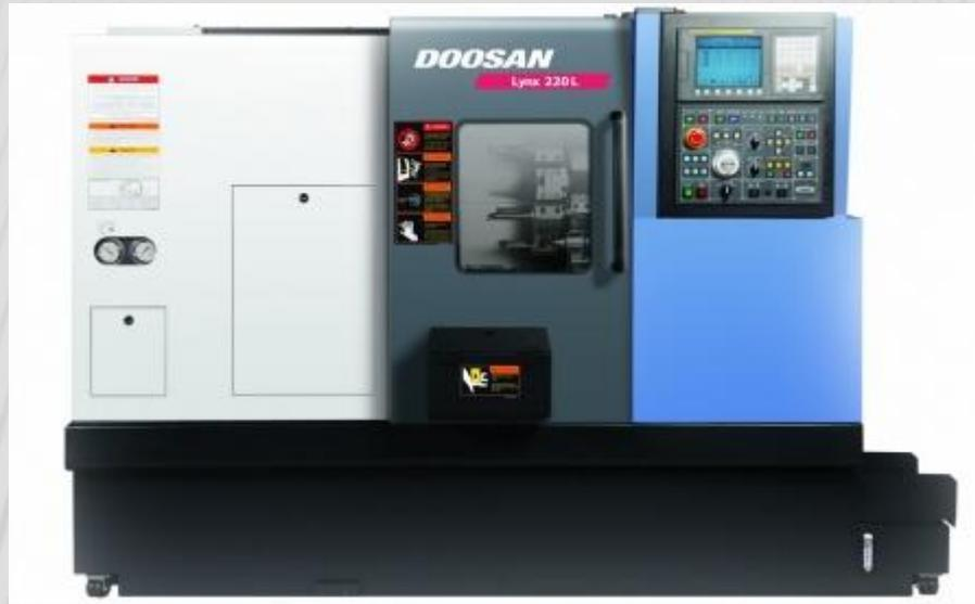
Компактний високошвидкісний центр, який виконує токарні та фрезерні операції. Токарний центр Lynx220LM з контр-шпинделем і з системою ЧПУ Fanuc OiTD створений для виробників, яким потрібен невеликий, надійний і високоефективний верстат для обробки складних деталей з однієї установки.
