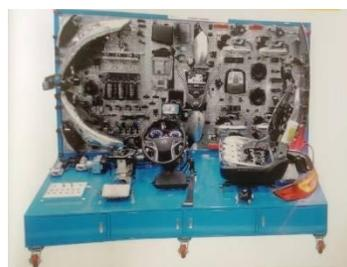
Стенд-тренажер «Электрооборудование автомобиля»
