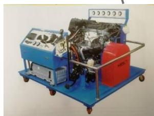
Стенд-тренажер «Действующий гибридный двигатель»
