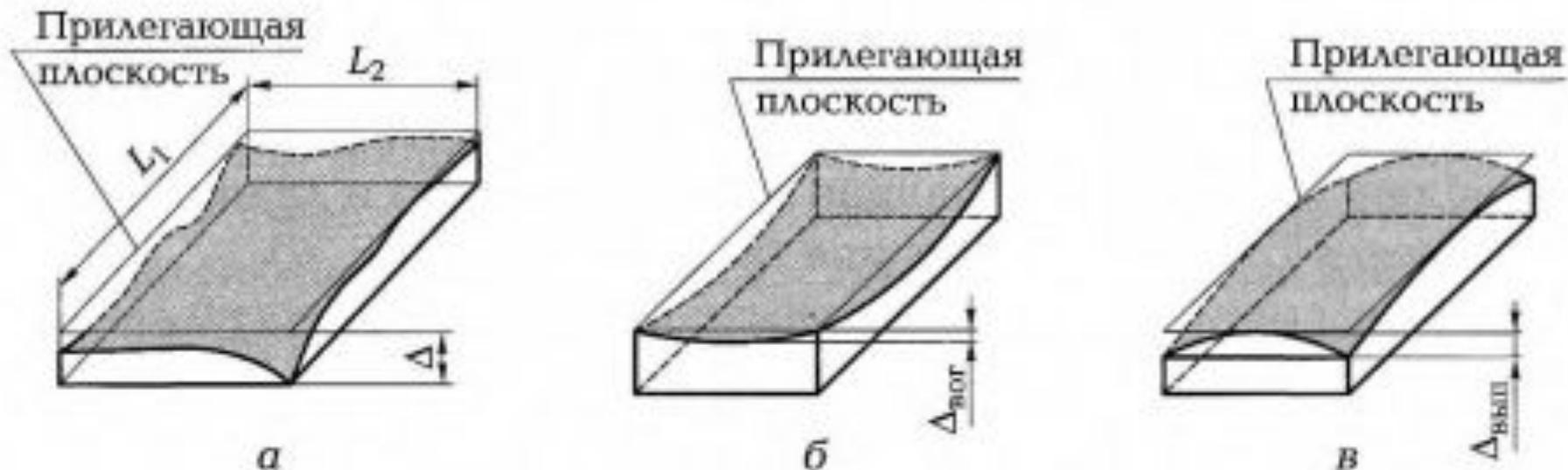
Рис. 2.18. Отклонения формы плоских поверхностей:
