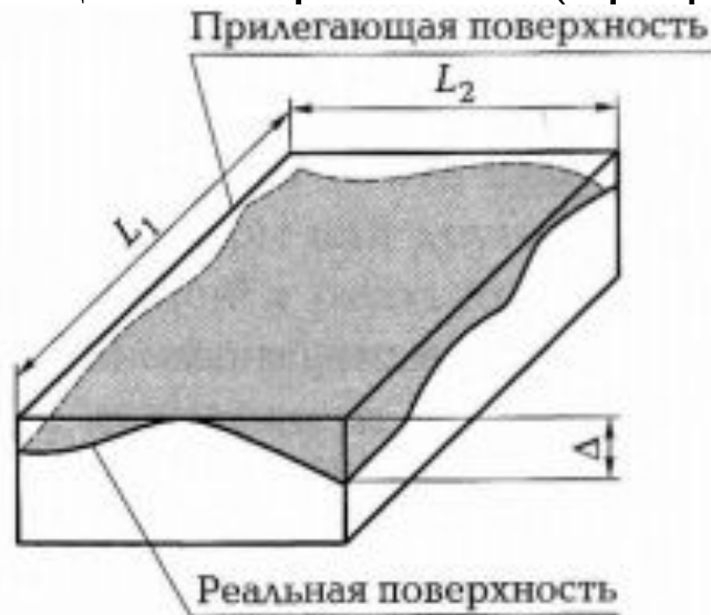
Рис. 2.15. Прилегающая плоскость и отклонение \Delta от плоскостности: L_1, L_2 — размеры нормируемого участка
