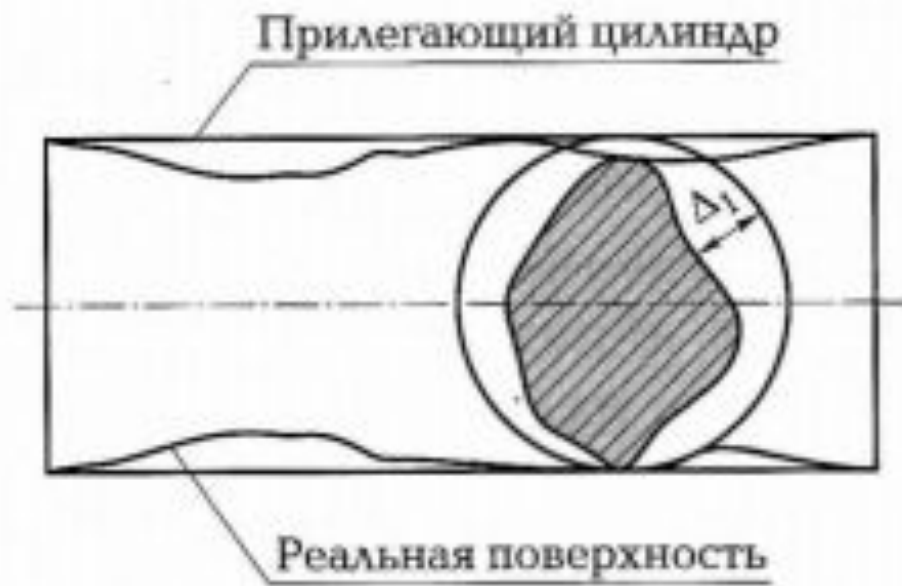
Рис. 2.14. Прилегающий цилиндр и отклонение \Delta_1 от цилиндричности
