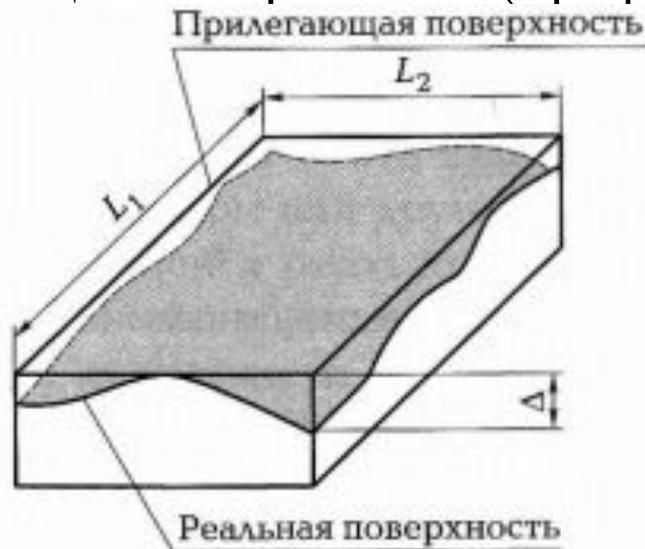
Рис. 2.15. Прилегающая плоскость и отклонение  $\Delta$  от плоскостности:
