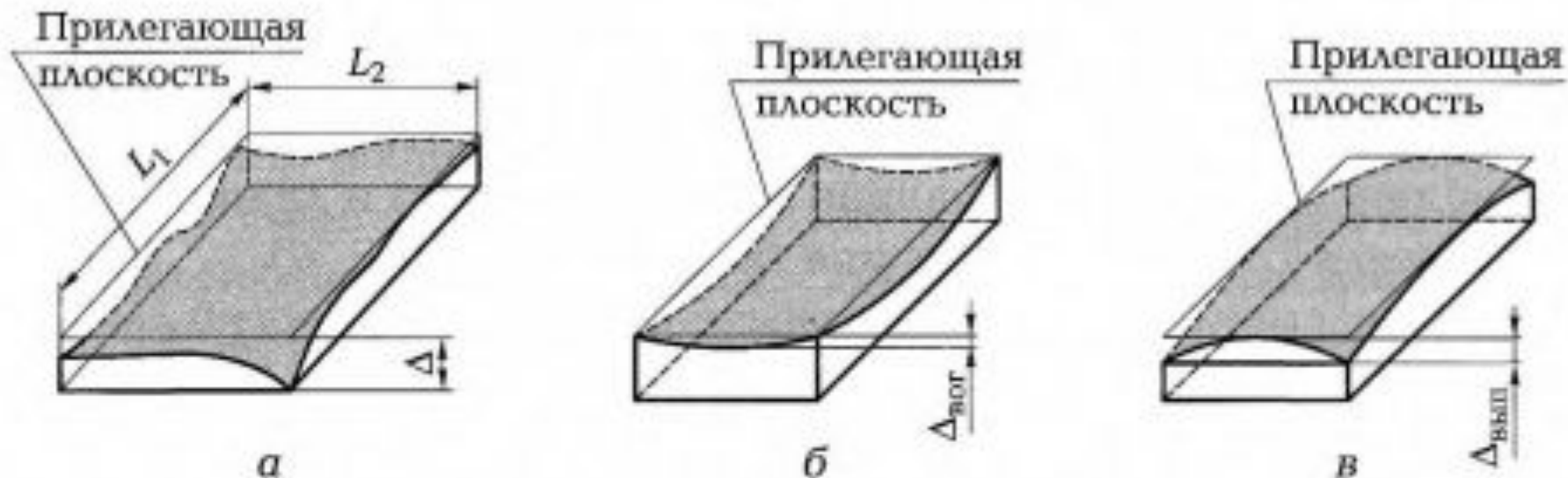
Рис. 2.18. Отклонения формы плоских поверхностей:
