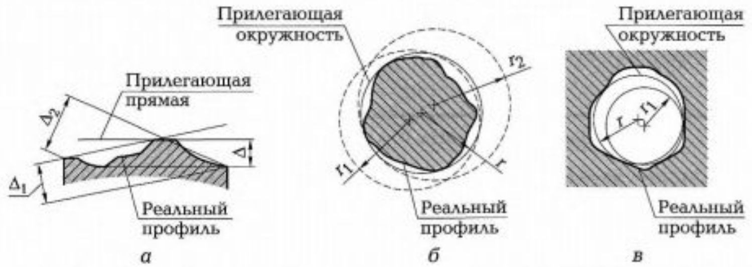
Рис. 2.13. Прилегающая прямая (а) и прилегающие окружности (б, в):
