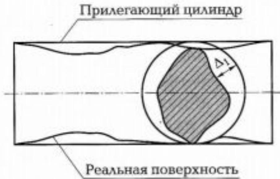
Рис. 2.14. Прилегающий цилиндр и отклонение  $\Delta_1$  от цилиндричности
