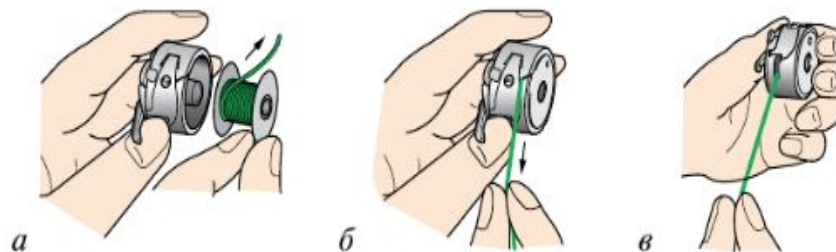
Рис. 5.24. Заправка шпульного колпачка
