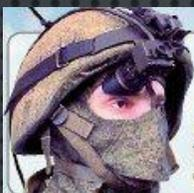
**Каска** может спасти жизнь бойца даже при прямом попадании пулевой пули с расстояния 5 м. Эта каска снабжена встроенной системой связи и монокулярным монитором. На него транслируется изображение с прицела на оружии.
