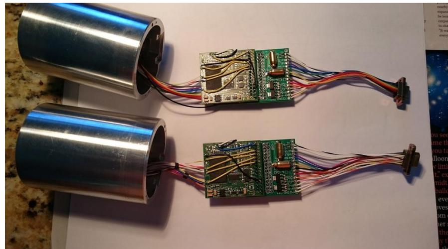
2. Два регистратора в разобранном виде. Каждый содержит по две платы с тремя аналоговыми входами и одну на интерфейсную плату. Размер: 100 X 50 мм.
