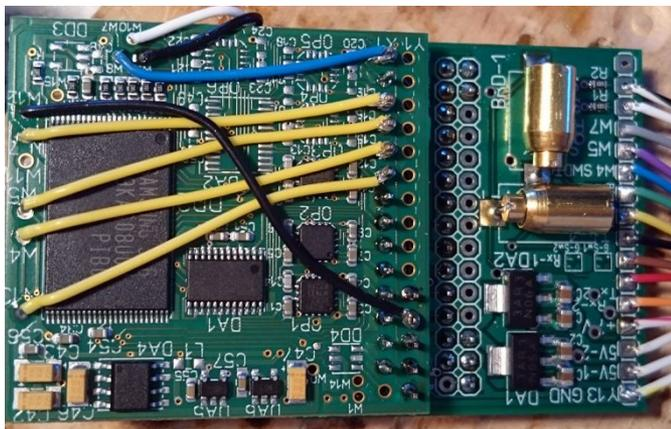
1. Плата с тремя аналоговыми входами. Размер: 42 X 41мм. Она напаяна на интерфейсную плату, на которой смонтированы два преобразователя напряжения и два динамических выключателя.
