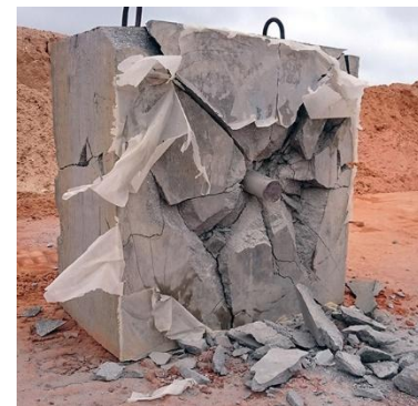
Мишень –бетон на расстоянии 5-ти метров от ствола
