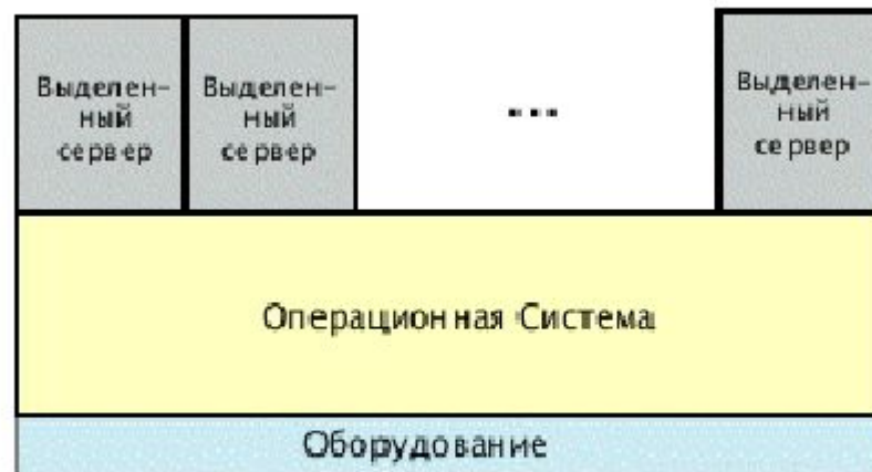
Рисунок 2.6 Виртуализация на уровне ОС
