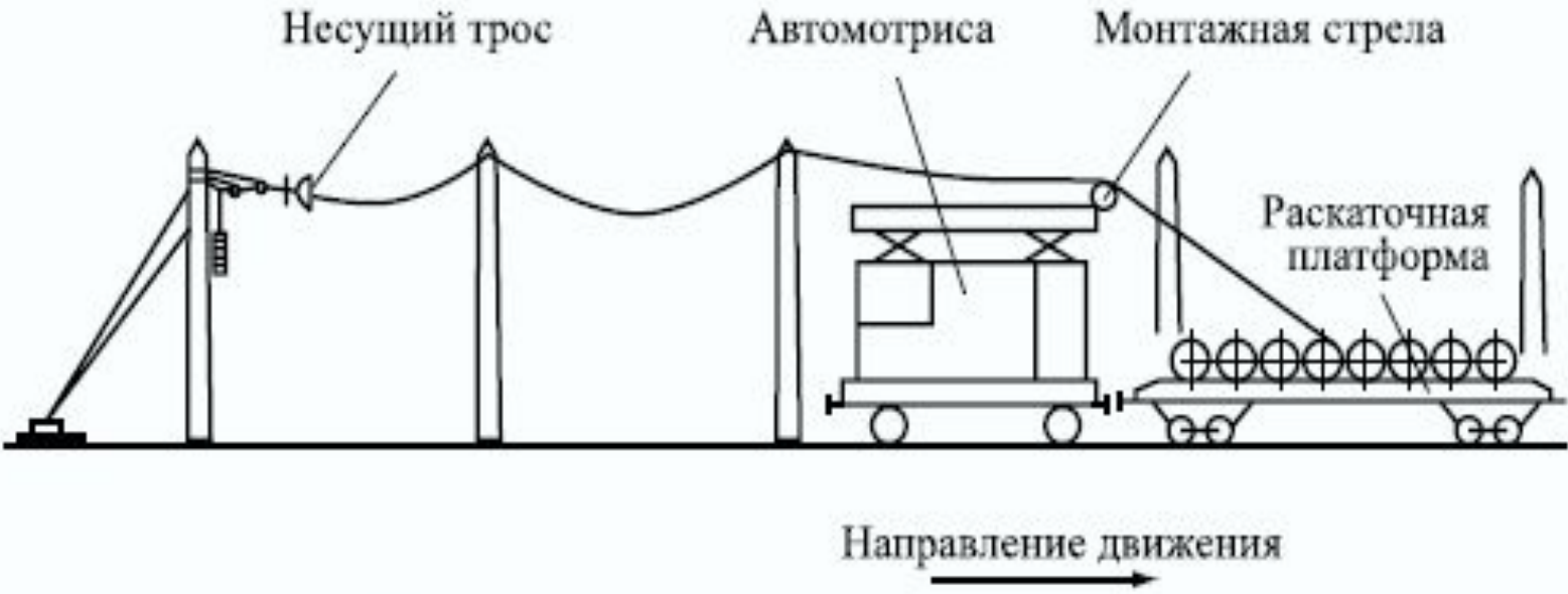
Рис. Схема раскатки несущего троса «поверху»
