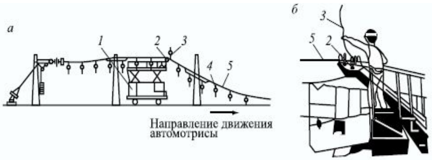
Рис. Схема подъема несущего троса с помощью монтажной стрелы автомотрисы (а) и прохода вертикальной звеньевой струны через ролик (б)
