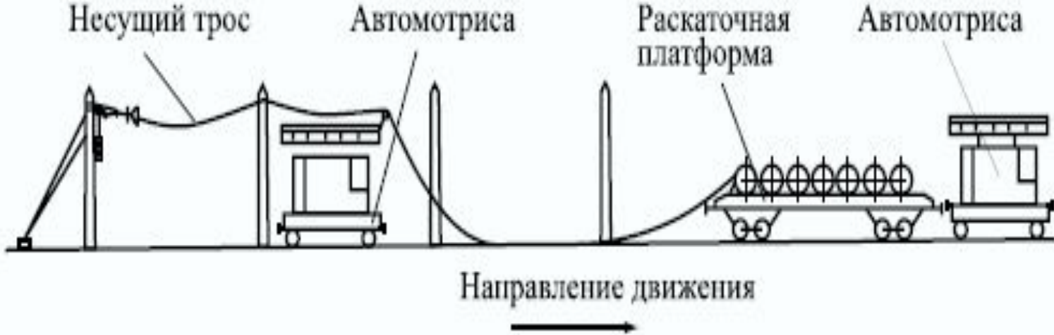
Рис. Схема раскатки несущего троса «поверху» с использованием двух авмотрис
