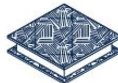
Комбинированная панель имеет с каждой стороны разные обшивки.
