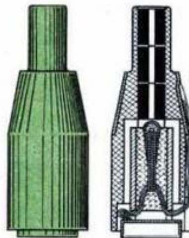
Рис. 327. Электрозавал ERZ 39 к 158,5-мм реактивной мине
