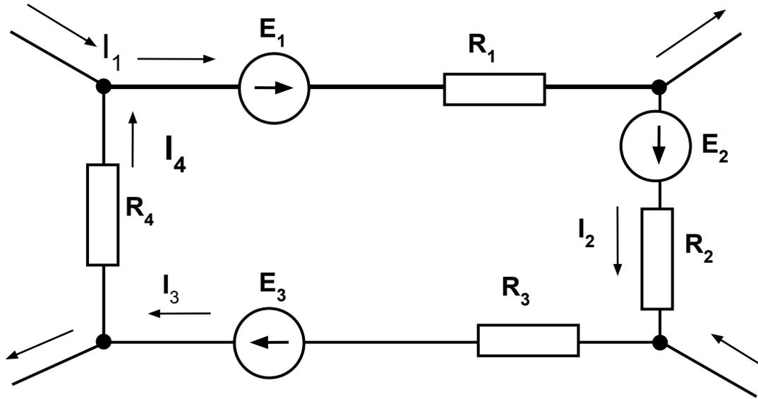
Обходим контур в произвольном направлении, например по часовой стрелке. Если направления Э.Д.С. и токов совпадают с направлением обхода контура то Э.Д.С. ( $E$ ) и падения напряжений ( $Ir$ ) берутся со знаком плюс, если не совпадают - со знаком минус:
