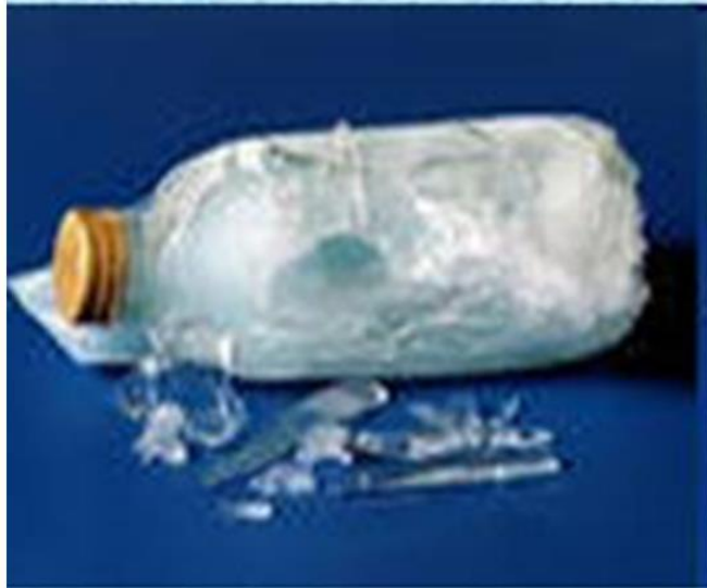
Бутылка с водой, лопнувшая при замерзании
