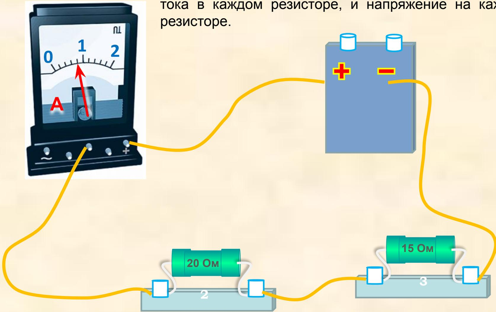
В эту цепь включены два резистора. Определите сопротивление второго резистора, общее сопротивление резисторов, силу тока в каждом резисторе, общее падение напряжения и напряжение на первом резисторе.
